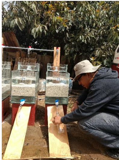
Figura 40: Toma de muestra de agua tratada a la salida del filtro
