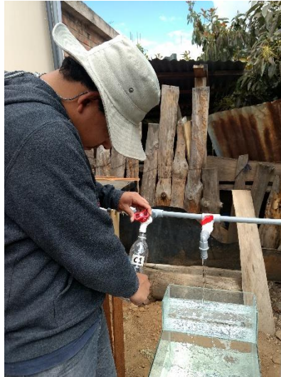
Figura 39: Toma de muestra de agua sin tratar
