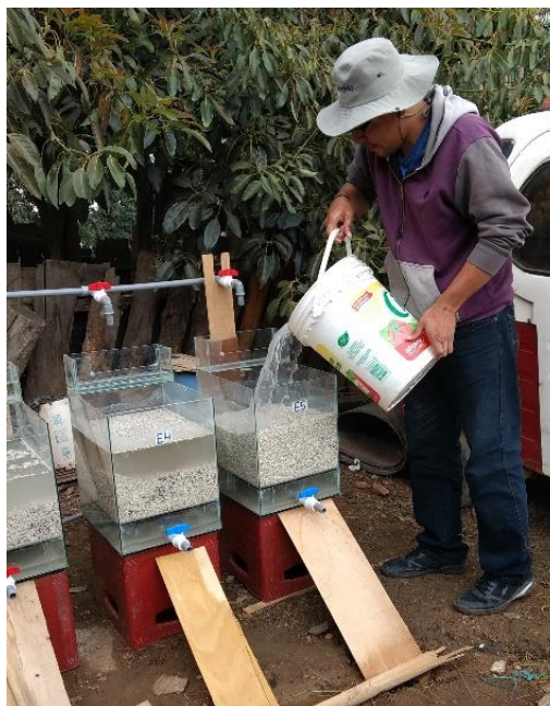
Figura 16: Vertimiento de salmuera a los filtros
