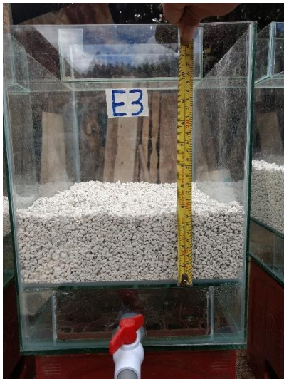
Figura 12: Filtro de zeolita de 9 cm.
