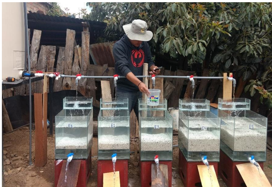
Figura 18: Regulación caudal de ingreso
