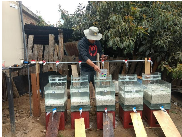
Figura 37: Regulación y medición del caudal entrante al filtro de zeolita
