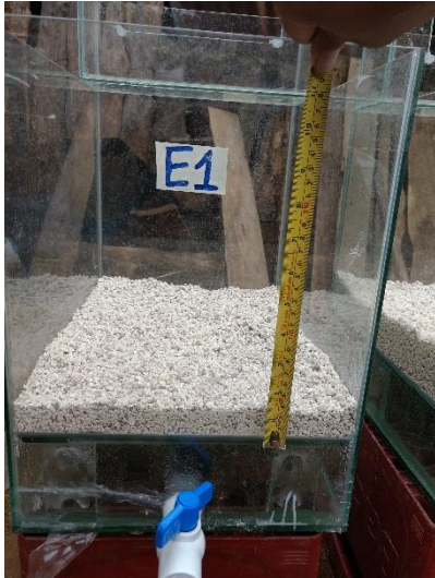
Figura 10: Filtro de zeolita de 3 cm.
