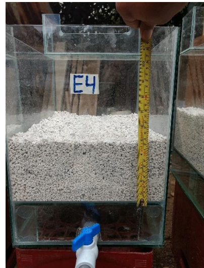
Figura 13: Filtro de zeolita de 12 cm.
