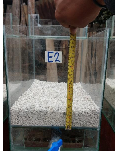
Figura 11: Filtro de zeolita de 6 cm.
