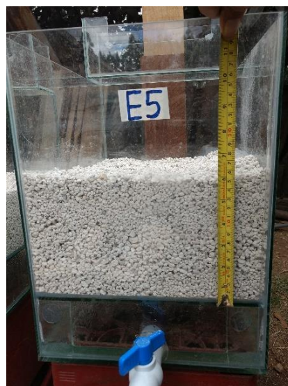
Figura 14: Filtro de zeolita de 15 cm.
