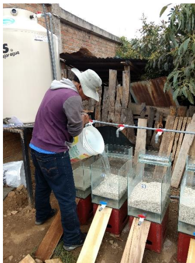
Figura 35: Vertimiento de salmuera en el filtro de zeolita
