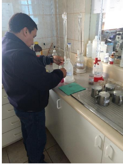
Figura 42: Análisis de dureza en el laboratorio
