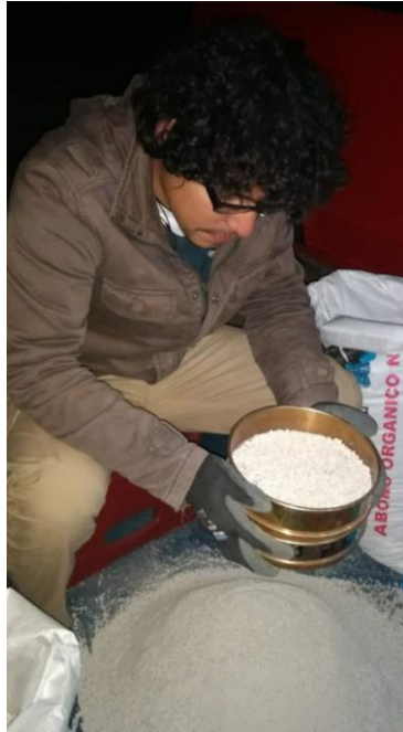
Figura 8: Tamizado de la zeolita
