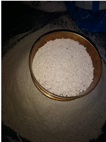
Figura 27: Material para filtro tamizado
