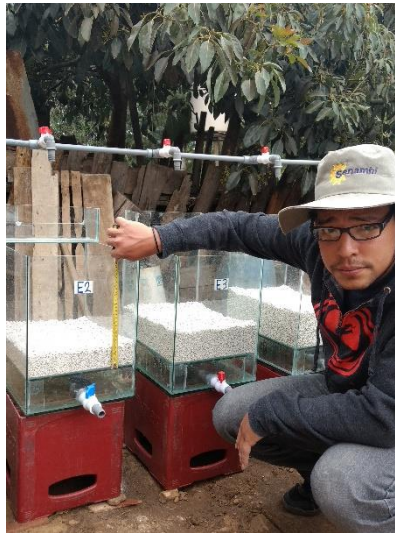
Figura 31: Colocación y medición de espesor del lecho filtrante
