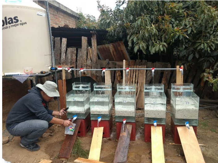
Figura 19: Regulación caudal de salida
