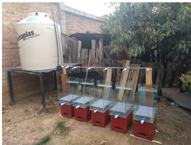
Figura 29: Colocación de los filtros en sus respectivos soportes
