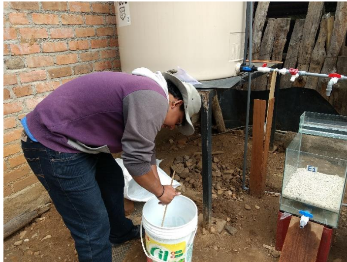
Figura 34: Mezcla y disolución de la sal en agua
