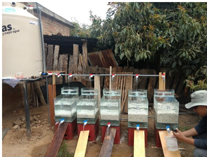
Figura 38: Regulación y medición del caudal saliente del filtro de zeolita
