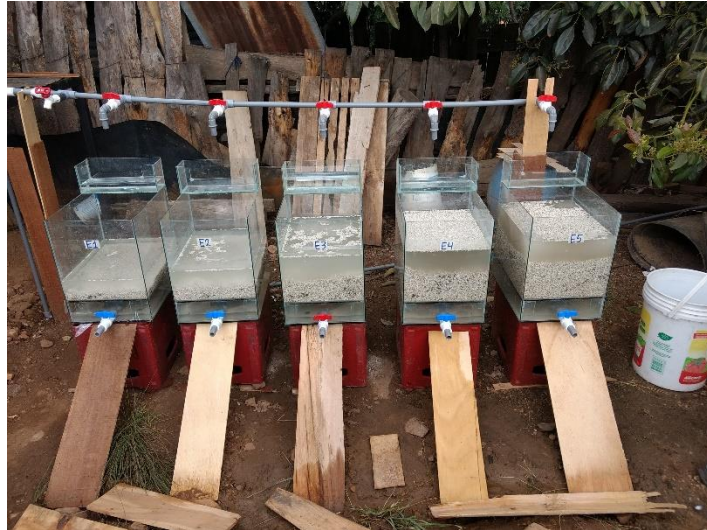
Figura 36: Material filtrante sumergido en una solución de salmuera
