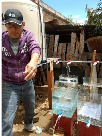
Figura 30: Prueba de hermeticidad y buen funcionamiento de los filtros
