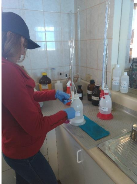
Figura 20: Titulación de muestra de agua filtrada
