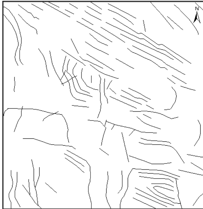
Figura 28. Lineamientos totales, extraídos del Filtro de High Pass, 2021.
