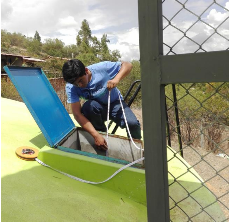
Foto N° 18: Midiendo alturas de agua en cada hora en el reservorio Circular 750 m3
