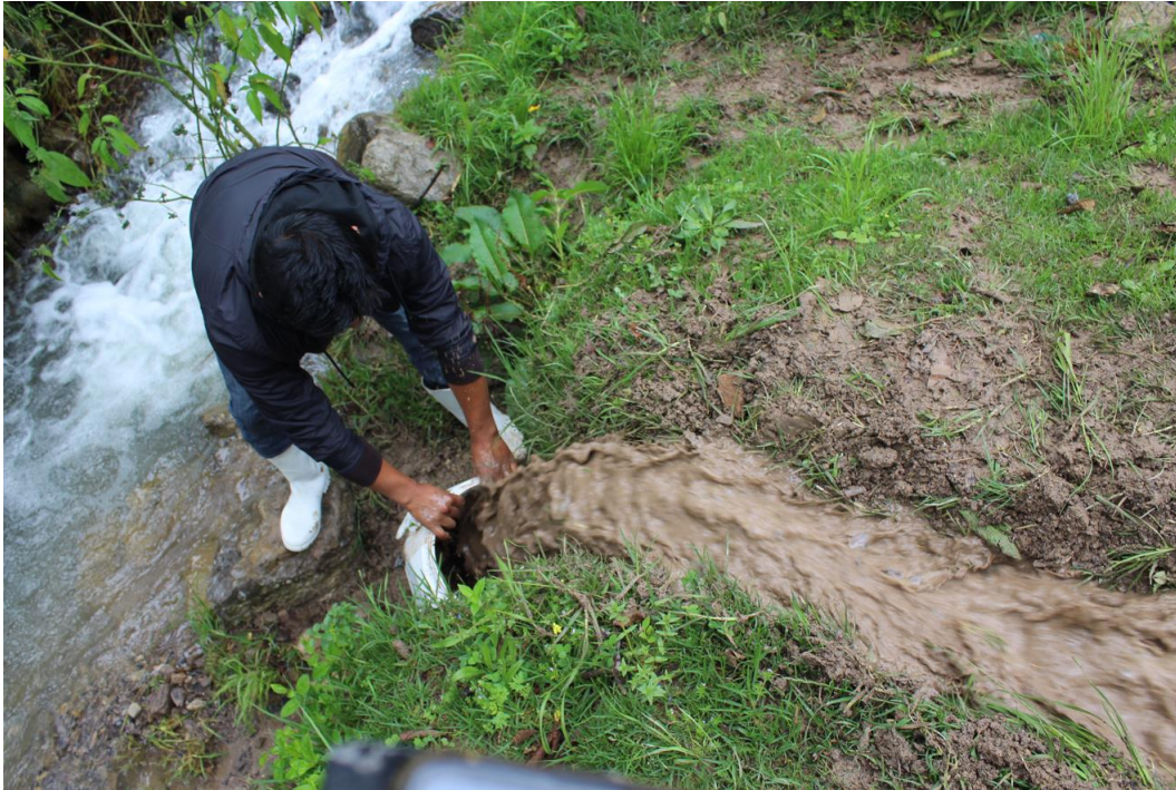
Foto N° 14: Realizando el aforo del manantial “La Huanga Negra”
