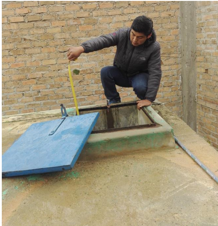
Foto N° 19: Midiendo alturas de agua en cada hora en el Reservorio (2-A)
