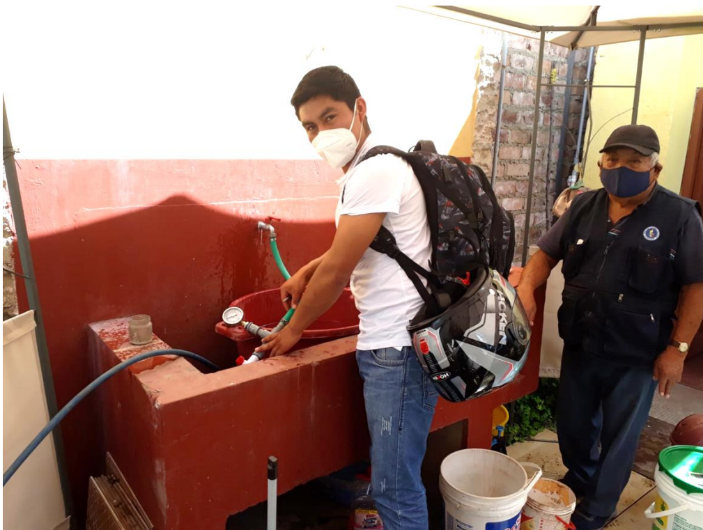
Foto N° 21: Midiendo la presión en las conexiones domiciliarias de la Loc. de Jesús
