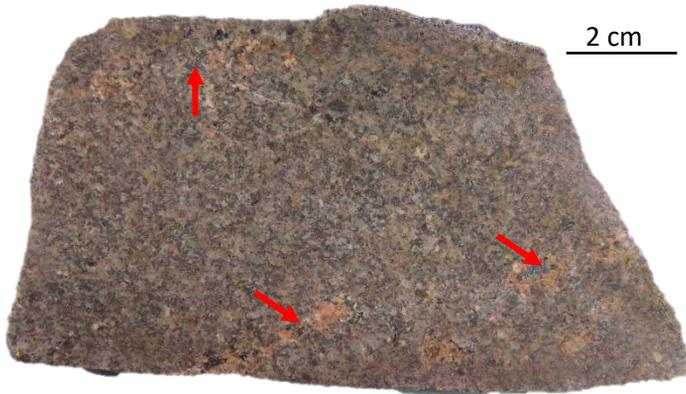
*Foto SB-03\_1* .- Superficie de cara de corte de la muestra de mano, de tonalidad verdosa y textura fanerítica. Compuesta por plagioclasa de tamaño sub- a milimétrico, euhedrales a subhedrales, siendo alteradas a sericita. Bajo la lupa, se observa cristales anhedrales de tonalidades negruzcas posibles magnetitas, presenta zonas de tonalidad rosada de posibles feldespatos potásicos (flechas rojas). La muestra corresponde a una roca aparentemente monzodiorítica.
