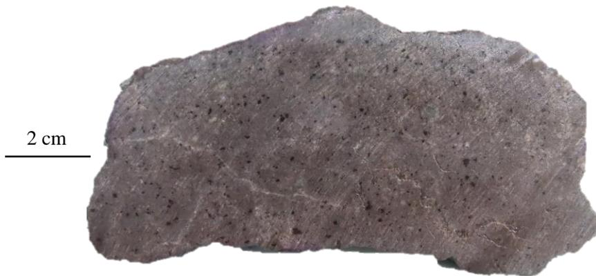
**Foto SB-07\_1.-** Superficie de corte de muestra de mano de color gris, leucocrática, de textura porfírica, correspondiente a una andesita. La muestra está compuesta principalmente por fenocristales de plagioclasas y una matriz afánítica compuesta por plagioclasas y clinopiroxenos. Presencia de cloritas alterando a minerales ferromagnesianos.
