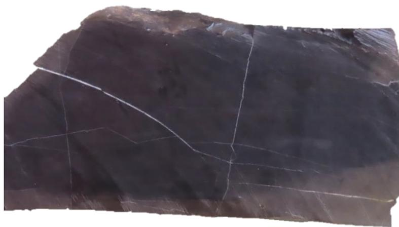
*Foto SB-01\_1.- Superficie de corte de muestra de mano de color negro, correspondiente a una caliza tipo mudstone. Bajo la lupa, se observan agregados dispersos de formas redondeadas de posible carbón? También se observa venillas delgadas de calcita atravesando la muestra.*
