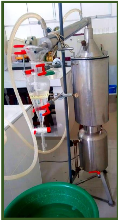
Sistema de extracción por arrastre de vapor.
