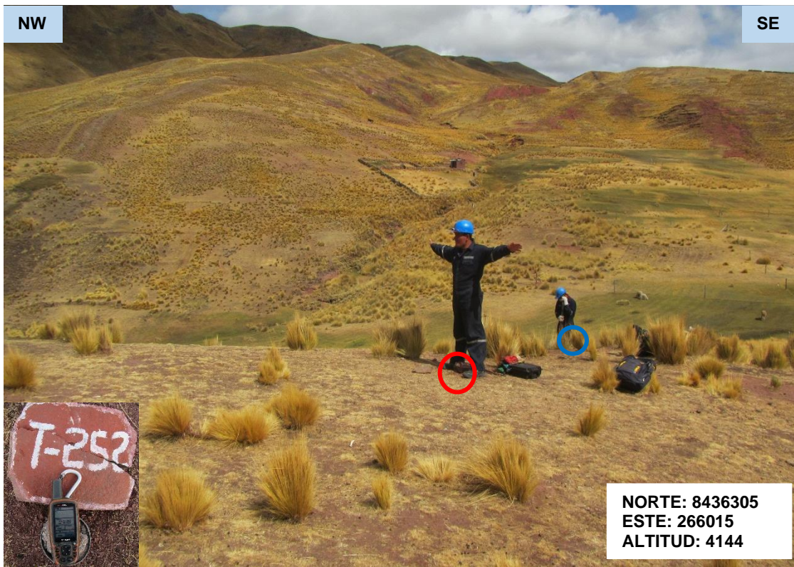
Foto 15: Ubicación de la T – 252, el círculo rojo viene a ser el centro donde se cimentará la estructura de la Torre, y el círculo azul es la calicata en la pata "C".
