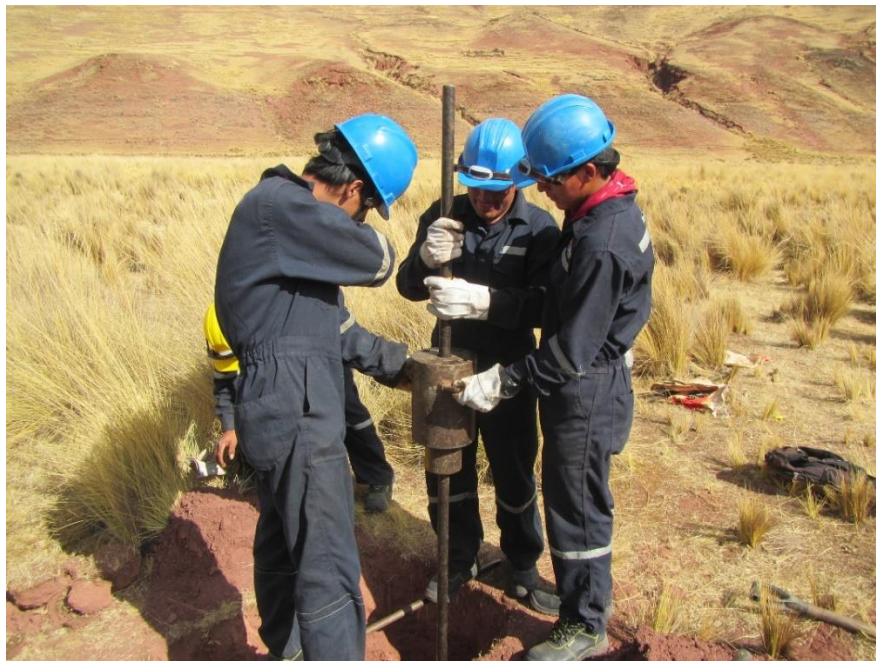
Foto 1: Realización de ensayo Standard Penetration Test (SPT).
