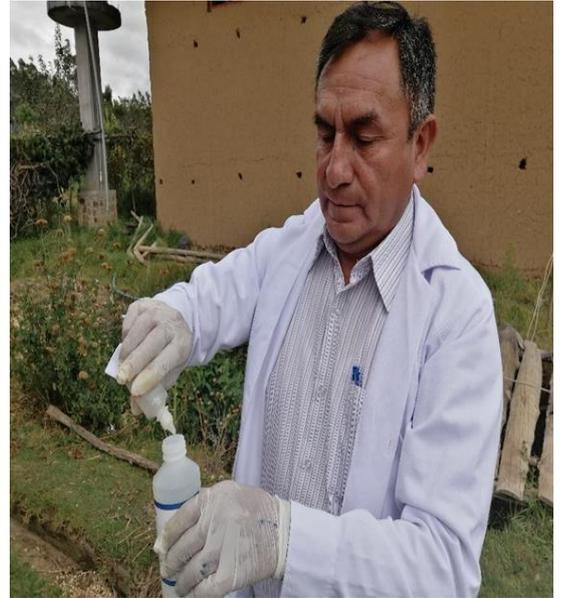
**Figura 11.** Adición de preservante a la muestra de agua MP - 3
