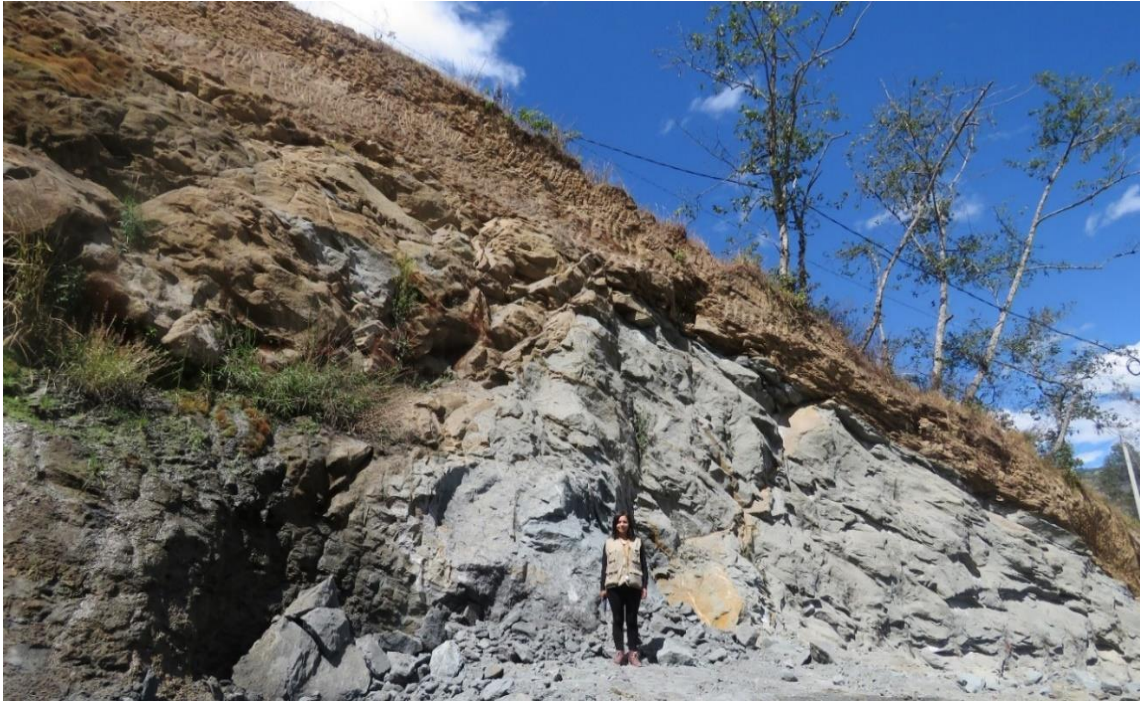
Fotografía 8: Contacto de arenas de color gris con limolitas de color marrón anaranjado. NW – SE. N: 9273364, E: 760694, C: 2419.
