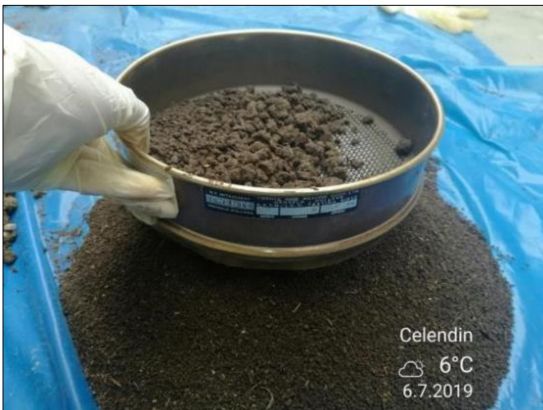
Figura 57. Tamizado de muestras de cada unidad experimental para su envío a laboratorio
