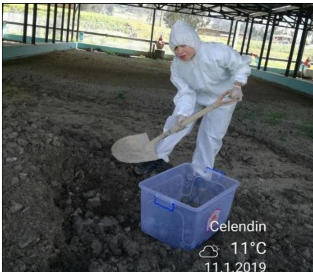
Figura 41. Extracción del material experimental (lodo residual) de los lechos de secado
