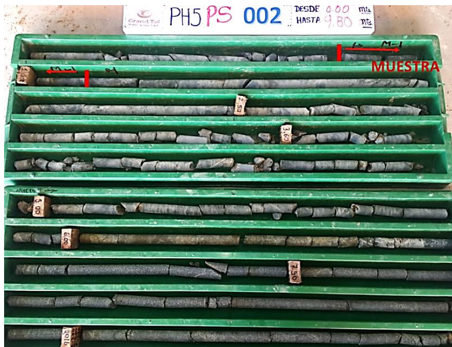
Figura 51: Caja con testigos de perforación, en primera corrida tramo mineralizado de hasta 40cm de espesor, con valores bajos en oro (0.06gr/tm)
