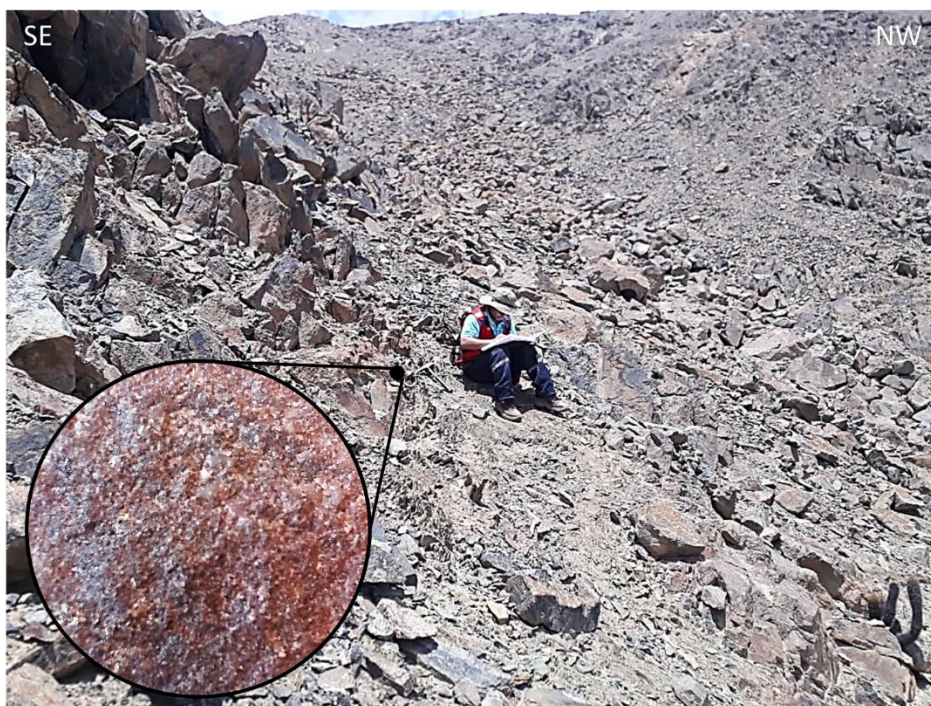
Figura 21: Muestra de roca volcánica andesítica de textura porfirítica
