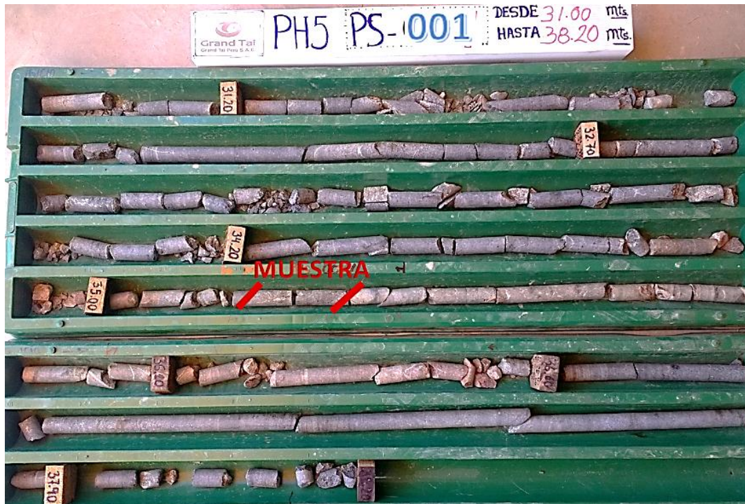
Figura 50: Caja con muestras, en el tramo 35.30m se evidencia ramal al piso de manto Virginia con valores bajos solo para oro (4.14gr/tm)
