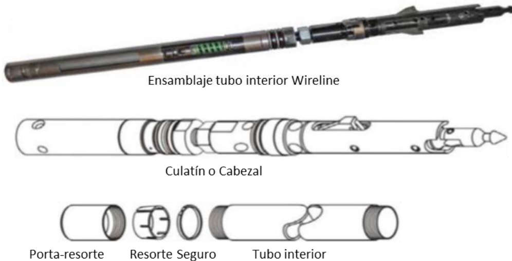
Figura 10: Componentes barril porta testigo. (Fuente: Seminario Sondajes DDH-A de Simone, J, Oyarzo, 2012)
