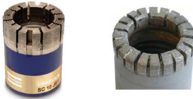
Figura 7: Corona de perforación. (Fuente: Seminario Sondajes DDH-A de Simone, J, Oyarzo, 2012)
