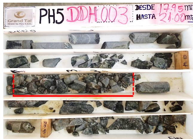
Figura 43: Muestra a los 20.10m de roca volcánica andesítica muy fracturada
