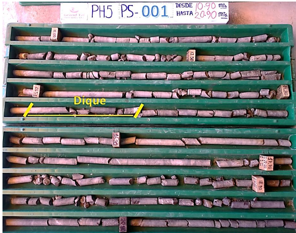
Figura 48: Caja con testigos, en tramo 14.90m se loguea dique silicificado de 40cm de espesor.
