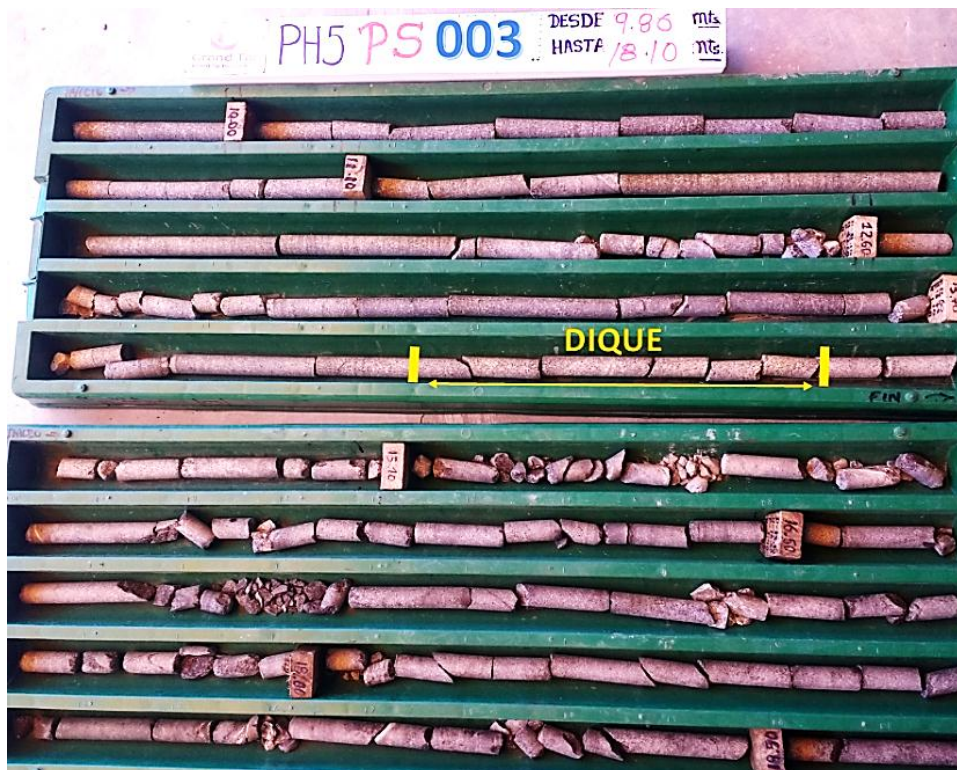
Figura 53: Caja con testigos, al tramo 13.90m dique andesítico (40cm), textura fanerítica.
