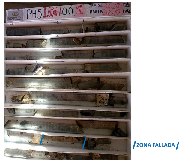
Figura 30: Tramos fallados de hasta 15cm, al metraje 41.80m.
