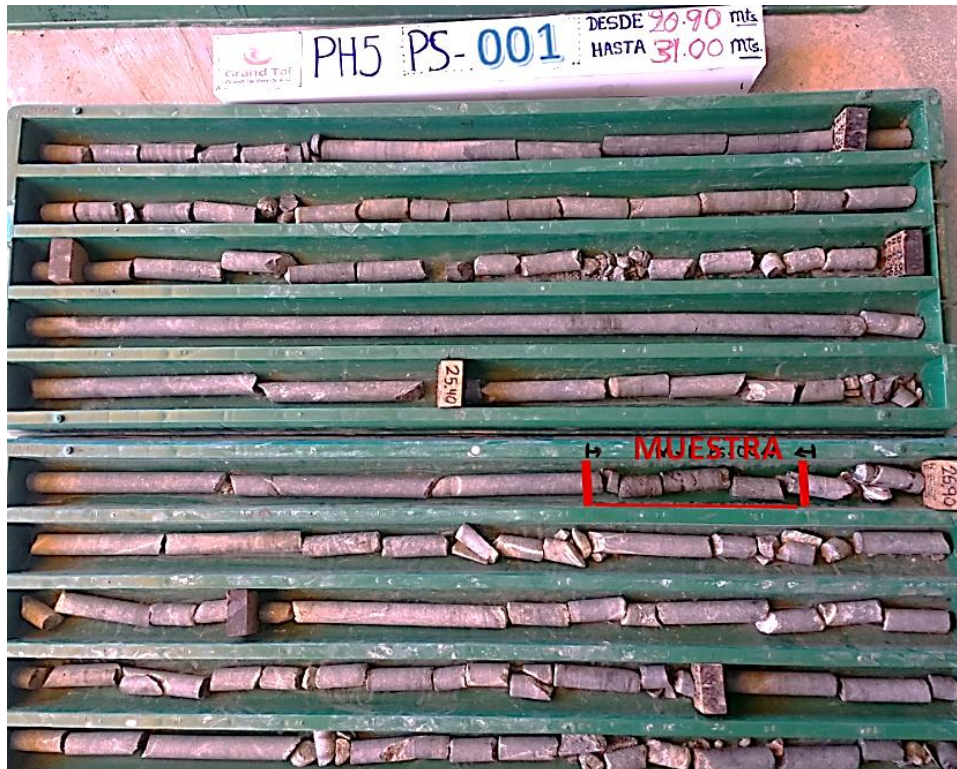
Figura 49: Caja con testigos, a los 26.50m, valores constantes en la mineralización de oro y cobre, siendo la proyección de Manto Virginia.
