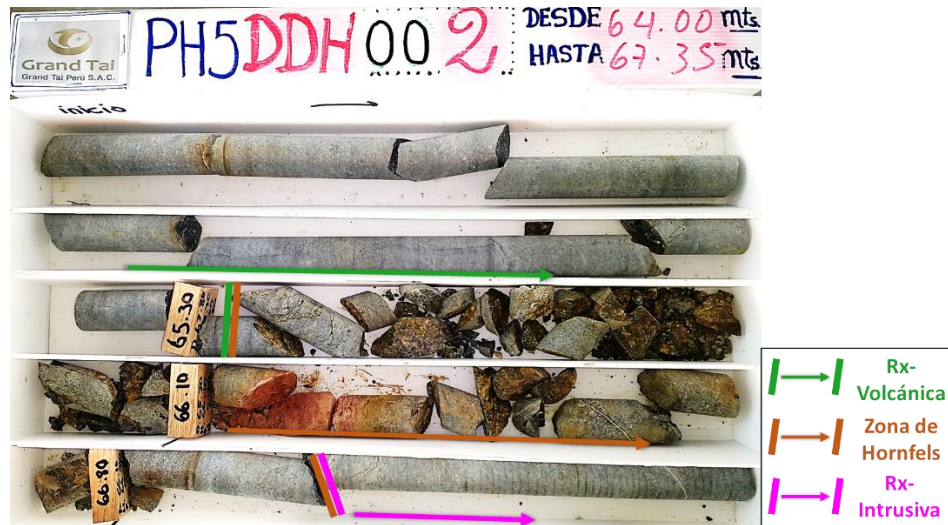
Figura 39: Caja con testigos en donde se evidencia zona de contacto entre roca volcánica e intrusiva, generando una zona de hornfels.
