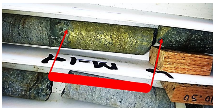
Figura 41: Muestra mineralizada de 10cm de calcopirita, pirrotita y pirita. Proyección de esplit al techo de manto Virginia.
