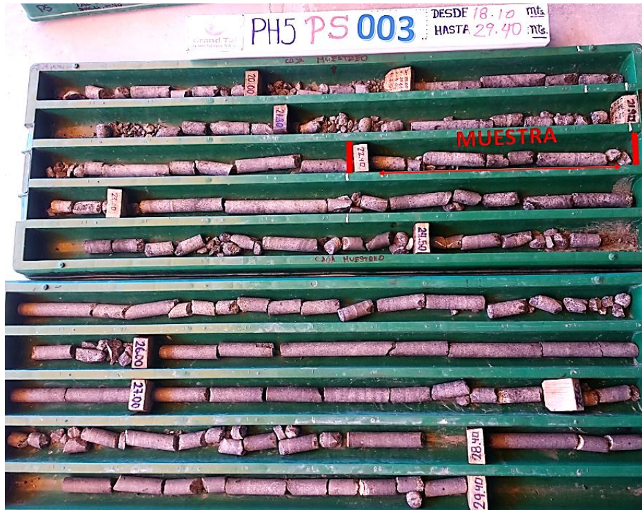
Figura 55: Caja con testigos, donde se determina a los 22.40m ramal al piso de manto Virginia con valores bajos de hasta 0.42ppm de oro
