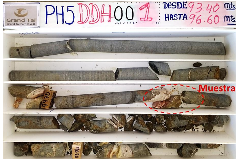
Figura 34: A los 94.80m se obtiene 10cm de muestra de carbonatos más arcillas rojas. Los valores son bajos; para oro (0.32gr/tm) y cobre (0.03%)
