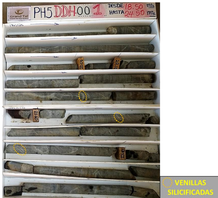
Figura 29: Caja de testigos, en ellos se evidencia venillas silicificadas de forma esporádica.
