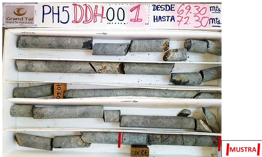
Figura 32: En rojo, muestra de 0.20m con valores bajos tanto para oro (0.06gr/tm) y cobre (0.05%)
