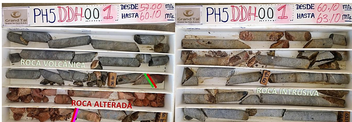
Figura 31: Tramo de 1.20m de alteración argílica, en contacto de intrusivo con roca volcánica.
