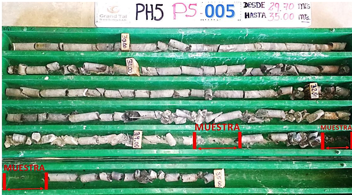
Figura 59: Caja con testigos de donde se saca muestras cuyos valores más representativos son 10.76ppm en oro en la última corrida.
