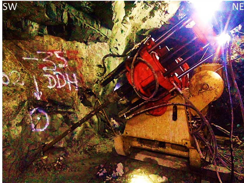
Figura 26: Máquina Lonyer 38 de largo alcance, hasta 150m. En perforación de sondaje DDH-02.
