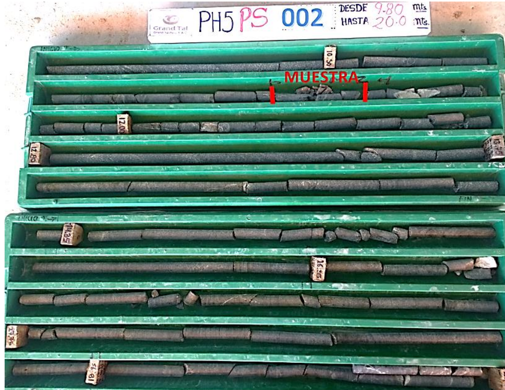
Figura 52: Caja con testigos, a los 11.50m de perforación diamantina se saca muestra con valores anómalos bajos para oro (0.47gr/tm) y cobre (0.05%)
