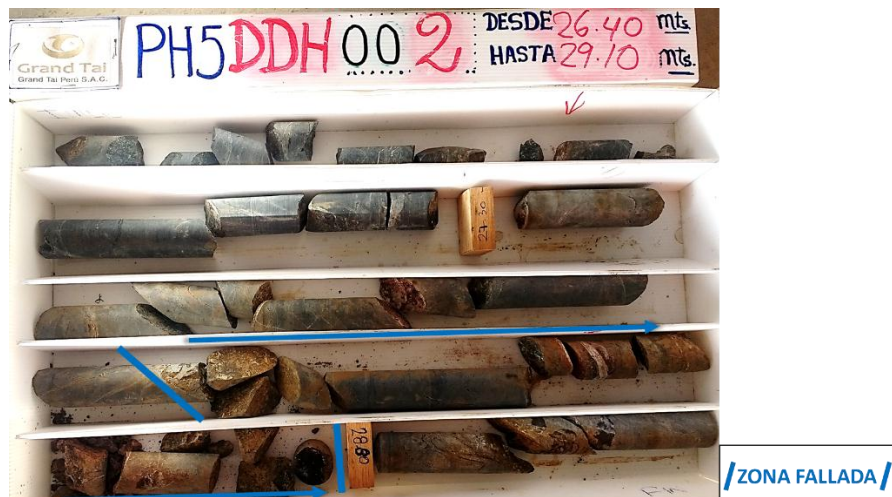
Figura 38: Zona fallada en azul, de 80cm de espesor, en el centro se determina arcillas rojas.
