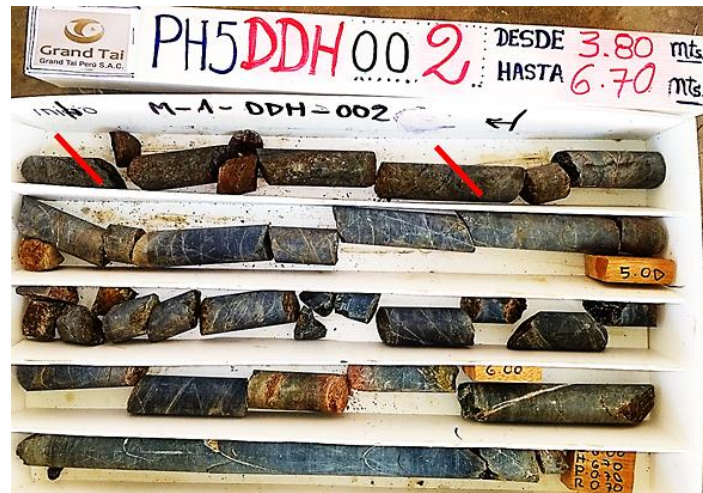
Figura 37: Core con estructura mineralizada de 30cm de espesor, ubicado en segunda corrida.
