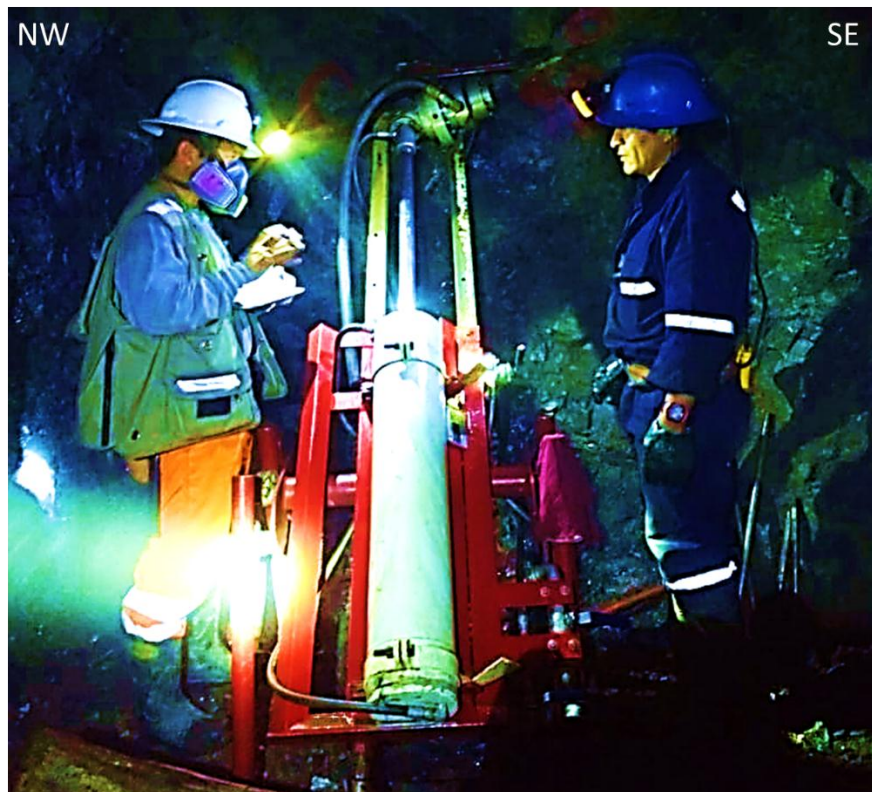
Figura 25: Máquina Pack Sack FL-50 de corto alcance, hasta 45m. En sondaje DDHPS-04
