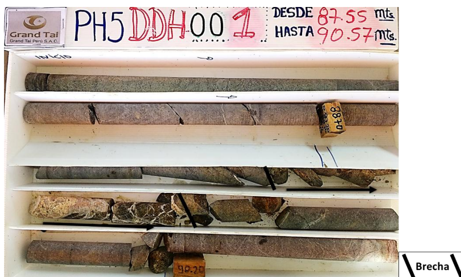
Figura 33: En línea negra zona de brecha de 0.50m de espesor
