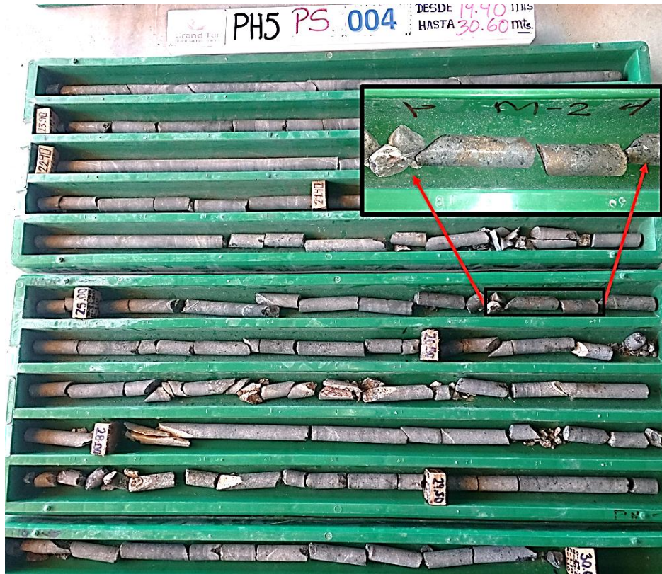
Figura 57: Caja con testigos en línea XRP. Se determina por logueo e interpretación geológica que hay ramal al piso de manto Virginia con valores bajos de hasta 2.15ppm en oro
