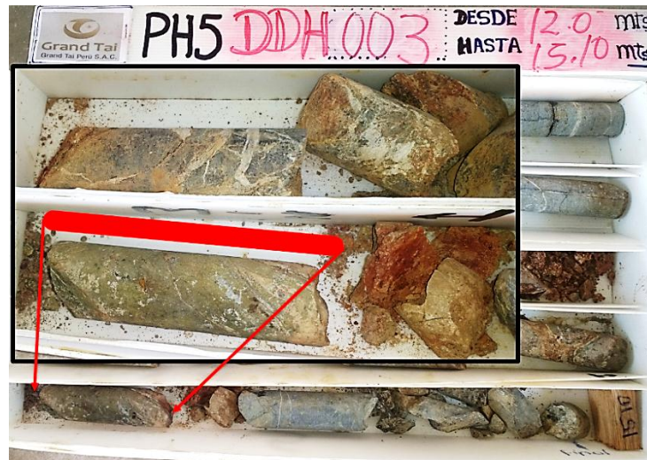
Figura 42: Caja con testigos, en tramo 14.30 se logea estructura mineralizada de 20cm con valores altos en oro (26.26gr/tm) siendo la proyección de Manto Virginia.
