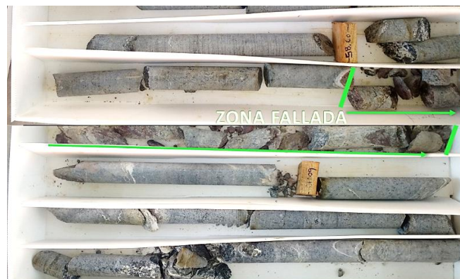
Figura 47: Caja con testigos, en el tramo 59.20m se loguea zona fallada de 0.60m. Con valores anómalos en oro (8.40gr/tm)
