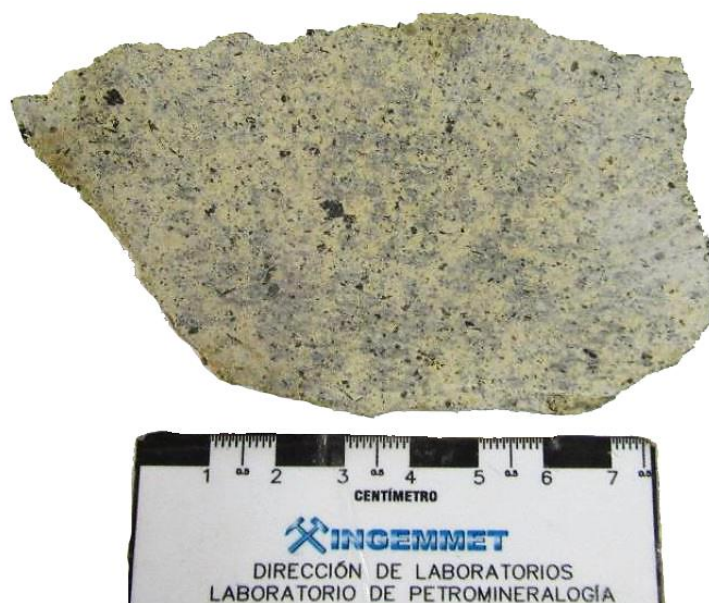
Figura 26. MGC-20: Roca ígnea (volcánica-piroclástica), compacta, de color pardo con tonalidad amarillenta, de textura fragmental. Están conformada por cristales y fragmento de cristales de feldespatos y ferromagnesianos, en una matriz afanítica. La muestra presenta densidad baja, dureza media y con magnetismo puntual. Fuente: INGEMMET, 2021.
