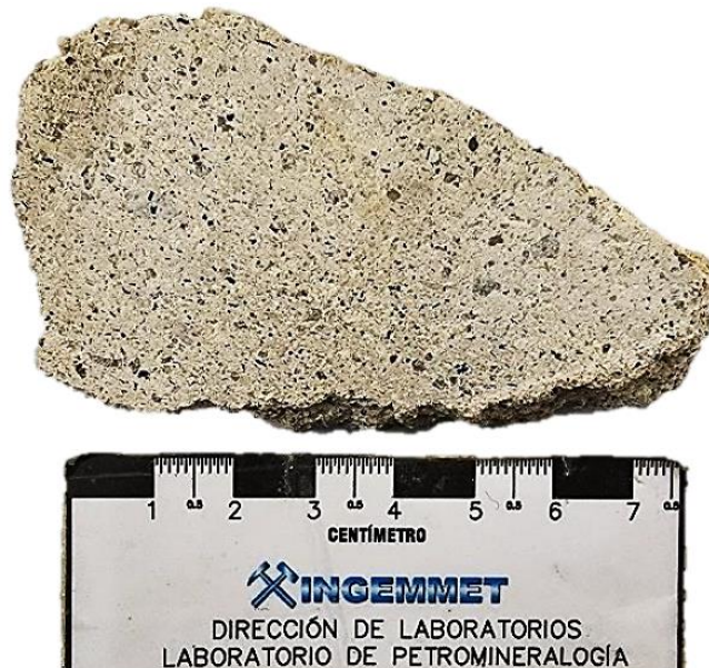
Figura 23. MGC-13: Roca ígnea (volcánica-piroclástica), compacta de naturaleza volcánica, de color blanco grisáceo, con textura porfírica. Está compuesta por fenocristales de cuarzo, plagioclasas y escasos minerales ferromagnesianos, dispuestos sobre una matriz afanítica vítrea. La roca posee densidad media a baja y dureza media, ausente de magnetismo. Fuente: INGEMMET, 2021.
