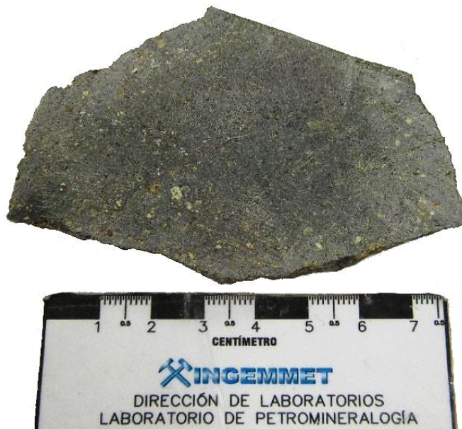
Figura 25. MGC-17: Roca ígnea (volcánica-efusiva), compacta, de color gris oscuro, de textura porfirítica. Está conformada por fenocristales de feldespatos y moldes de cristales reemplazados por carbonatos, en una matriz afanítica. La roca presenta dureza y densidad media, con magnetismo débil; además con débil efervescencia en moldes de ferromagnesianos. Fuente: INGEMMET, 2021.
