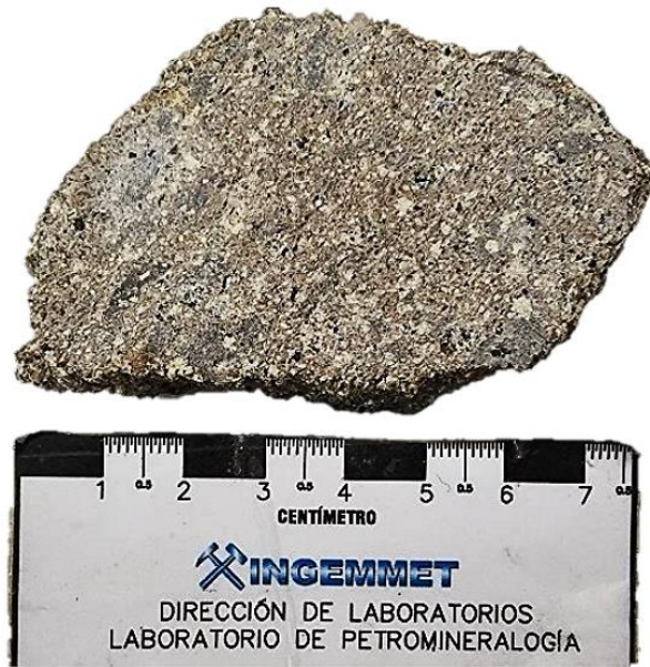
Figura 22. MGC-11: Roca ígnea (volcánica-efusiva), compacta de naturaleza volcánica, de color gris medio con tonalidad parduzca, con textura porfírica. Está compuesta por fenocristales de cuarzo, plagioclasas y escasos minerales ferromagnesianos, dispuestos sobre una matriz afanítica vítrea, se aprecian estructuras vítreas alargadas. La roca posee densidad media a baja y dureza media. Ausente de magnetismo. Fuente: INGEMMET, 2021.
