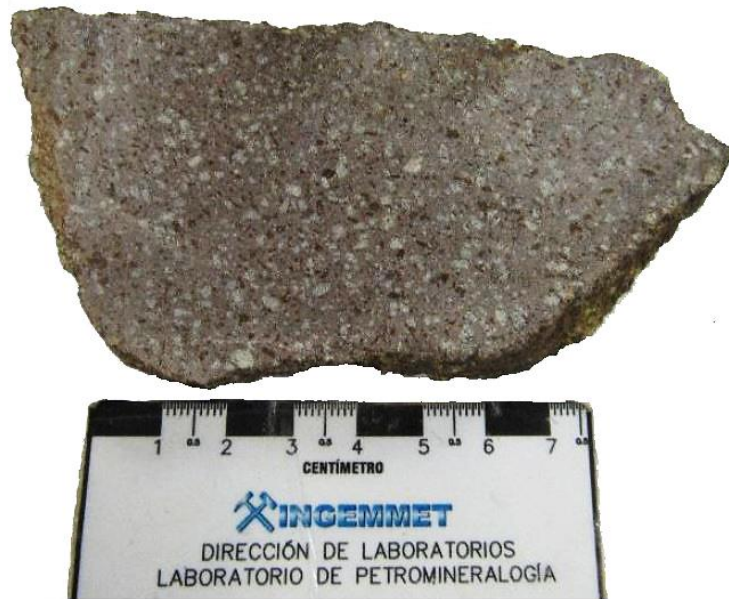
Figura 24. MGC-14: Roca ígnea (volcánica-efusiva), compacta, de color gris pardo con tonalidad rosácea, de textura porfirítica. Está conformada por fenocristales de feldespatos y ferromagnesianos, distribuidos en matriz afanítica impregnadas por óxidos de hierro. La muestra presenta densidad y dureza media, con magnetismo muy débil. Fuente: INGEMMET, 2021.
