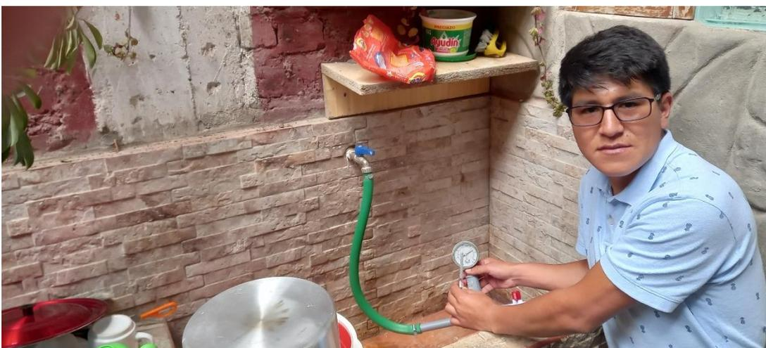
**Figura N° 42:** Realizando los registros de las presiones en las casas más cercanas a los nodos de la red de distribución
