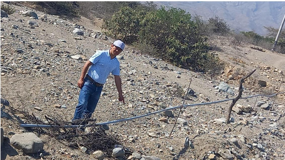
**Figura N° 41:** Registro de presiones en la última conexión domiciliar de la red de distribución
