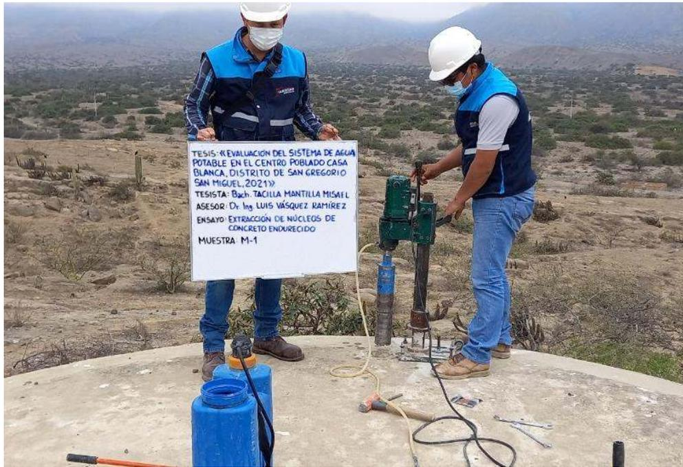
Foto N° 01: Montaje del equipo de perforación para la extracción de núcleo de concreto endurecido del Reservorio, muestra M-1.
