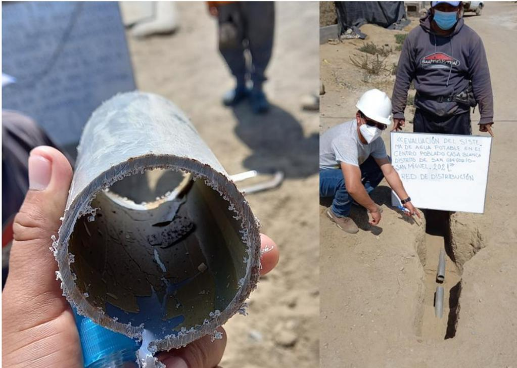
La red de distribución, en todos los tramos que se verificó con corte en la tubería se encontró obstrucción de una capa en las paredes internas de la tubería, alrededor de su diámetro interno, cuya dureza de material encontrado por no ser de espesor considerable es fácil, se trata de una capa solida de color marrón, que al fraccionarlo y ponérselo en contacto con el agua se diluye con facilidad.
