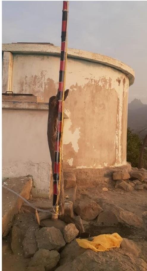
**Figura N° 33:** Midiendo la profundidad total del pozo
