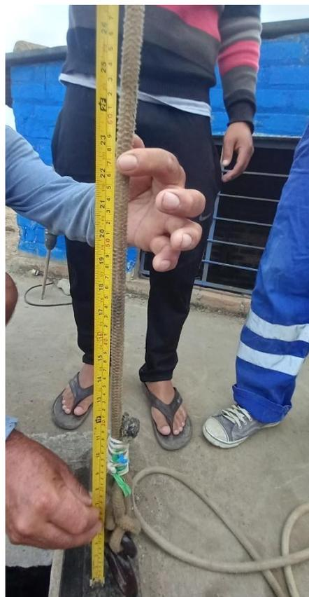
**Figura N° 34:** Nivel estático del pozo, en su máxima capacidad de almacenamiento
