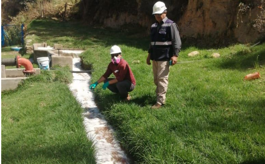
Figura 29: Aforo por el método del flotador
