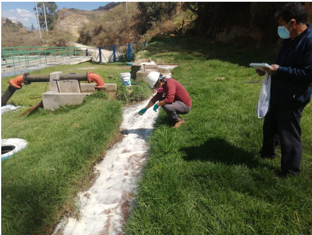
Figura 33: Aforo por el método del flotador
