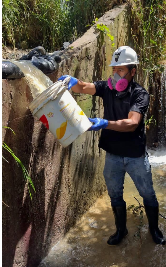
Figura 26: Aforo por el método volumétrico
