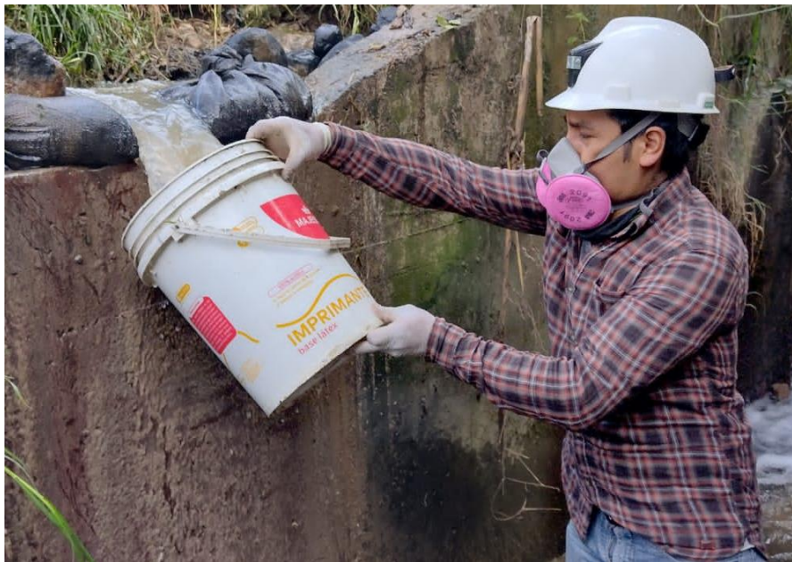
Figura 30: Aforo por el método volumétrico
