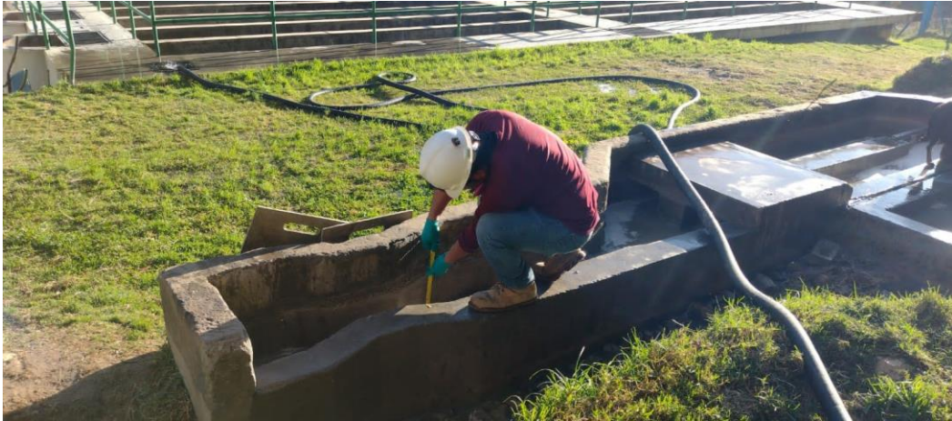
Figura 23: Toma de medida de la profundidad del flujo
