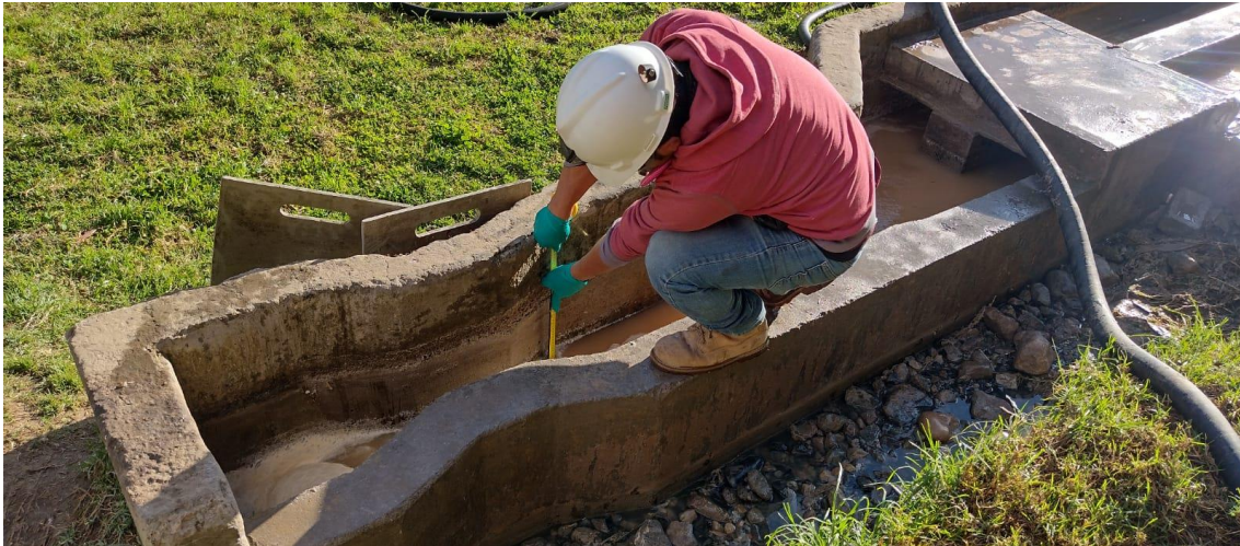
Figura 31: Medida de la profundidad del flujo
