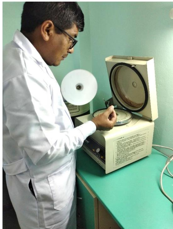
Figura 2. Colocando el tubo capilar en la centrífuga de micro hematocrito
