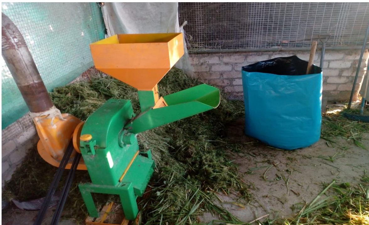
Figure 2: picadora empleada en la elaboración del silaje
