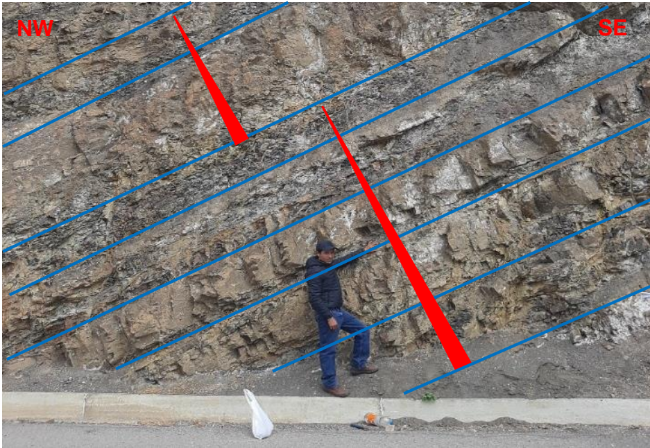
Fotografía 35: Visualización de la secuencia directa en estratos de areniscas y limolitas. Coordenadas N:9178310, E: 817906 y Cota: 2358 m.s.n.m.
