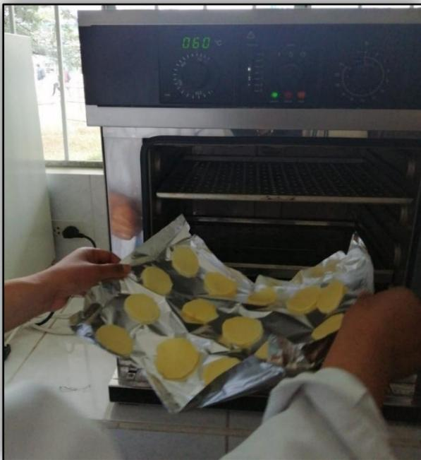
**Muestras en estufa - Secado de rodajas de papas en bandejas**
