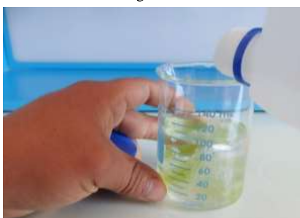
Foto N° 11: Preparación del coagulante en una disolución con agua destilada
