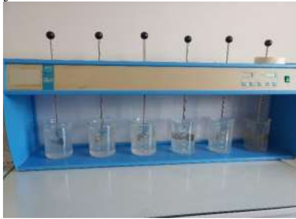
Foto N° 16: Aplicación de la prueba de jarras
