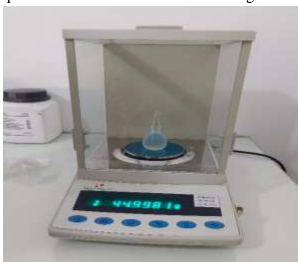
Foto N° 19: Peso del Picnómetro de vidrio para el cálculo de la densidad del coagulante
