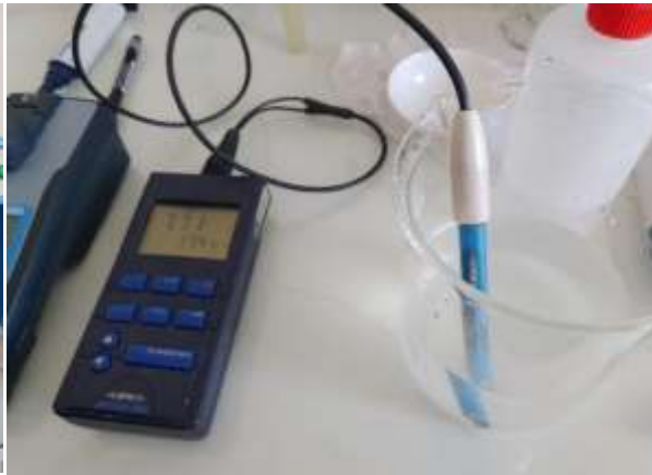
Foto N° 17: Medición de pH de los resultados
