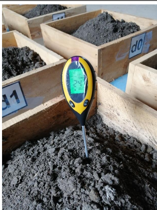
Monitoreo de temperatura y humedad
