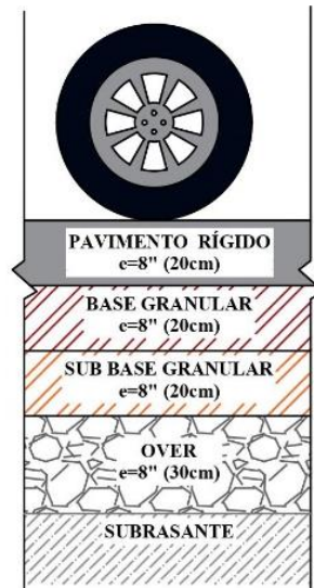
ESTRUCTURA DE PAVIMENTO EVALUADO ESC:1/25
