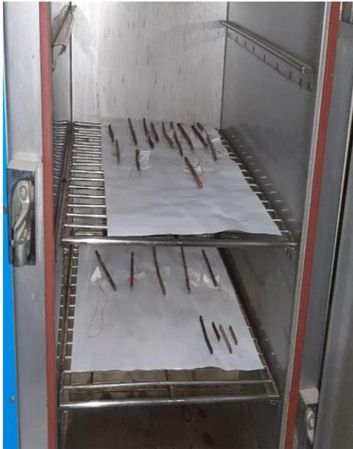
Foto 10. Secado de muestras de madera en estufa
