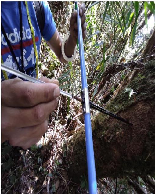
Foto 8. Extracción de muestra de madera con barreno de Pressler
