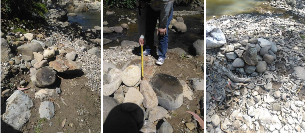
Figura 23: Material superficial de calicatas aguas arriba y abajo de captación Río Porcón.
