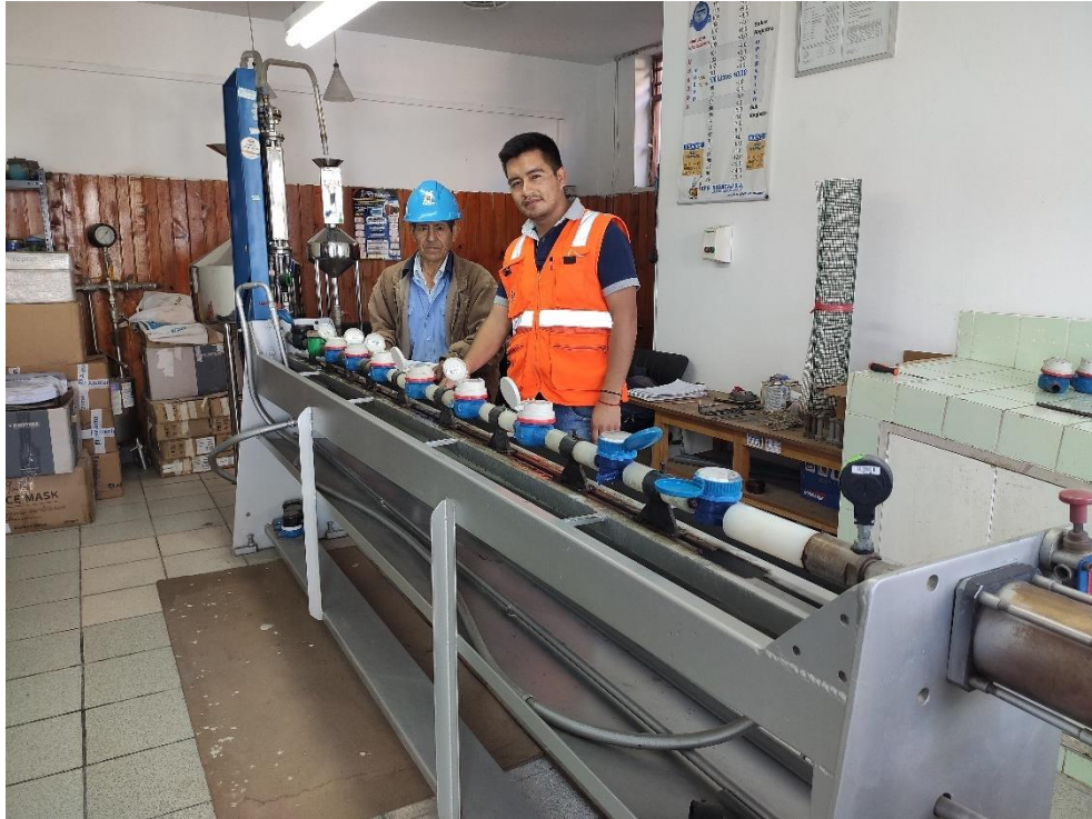
Figura 68: Contrastación de medidores en banco de pruebas.
