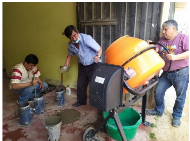
Figura 32 Elaboración de probetas de concreto
