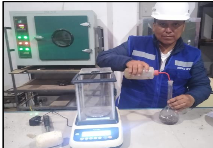
Fotografía 10: Peso muestra seca que pasó el tamiz N°4 – Ensayo de Peso específico de Sólidos.
