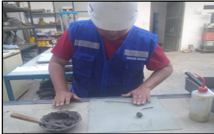
Fotografía 9: Molde de la muestra en forma rollos de 3mm – Ensayo de Límite Plástico.
