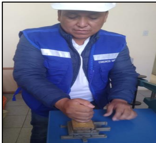
Fotografía 11: Adaptación de la muestra en la caja de corte – Ensayo
