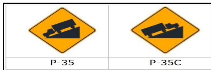
Figura 6: Señales Preventivas – Pendiente Longitudinal
