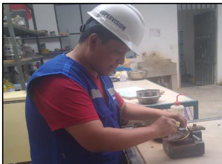
Fotografía 8: División de la muestra con el ranurador en el recipiente de Casagrande – Ensayo de Límite Líquido
