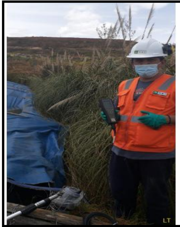
Figura 8. Toma de los parámetros de campo pH, Conductividad, temperatura, en la poza sin tratar.
