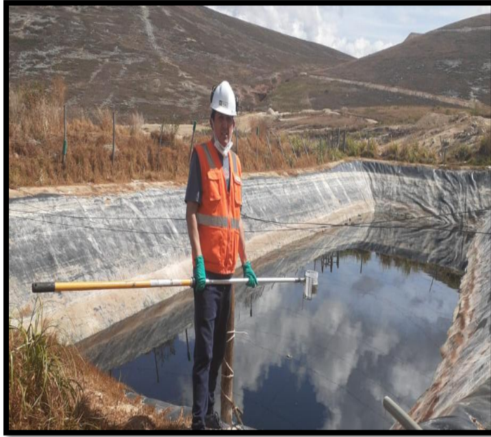
Figura 10. Toma de muestra en la poza sin tratar con ayuda del brazo telescópico
