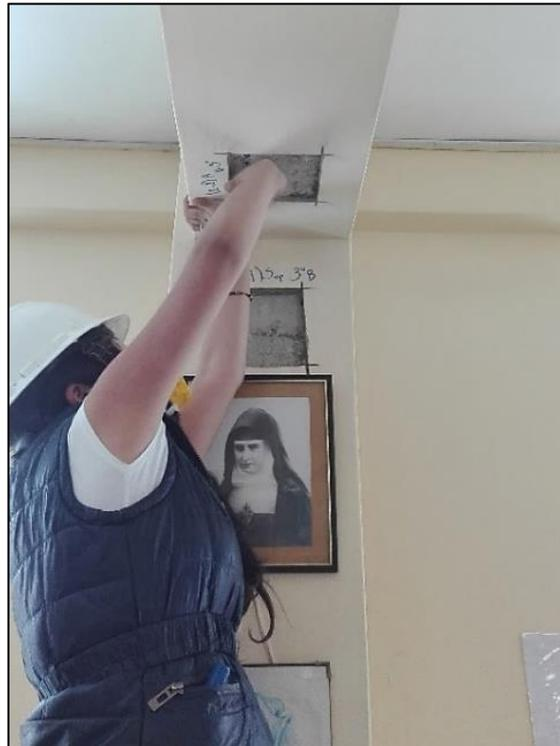
**FOTO 06.** *Ensayo de esclerometría en vigas y columnas*
