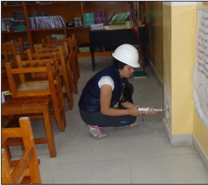
**(a)** Ensayo en columnas
