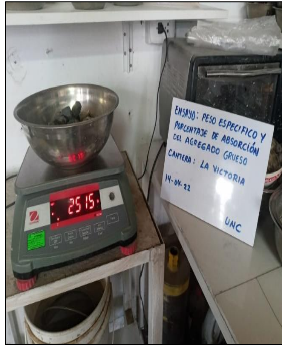
Foto N°14: peso de la muestra sumergida en agua del agregado grueso.
