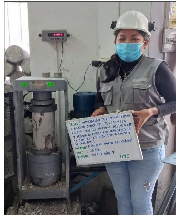
Foto N° 36: fractura tipo 2, probeta ensayada a los 28 días método MF 280 kg/cm 2
