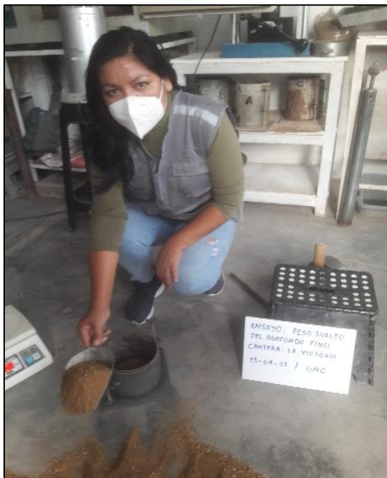
Foto N°07: se coloca la muestra en el molde para el ensayo del peso suelto del agregado fino.
