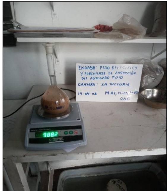
Foto N°12: peso de la muestra + agua + picnómetro con agregado fino.
