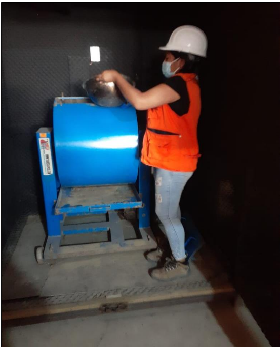
Foto N°15: se coloca la muestra en la máquina de los ángeles para el ensayo a la abrasión.
