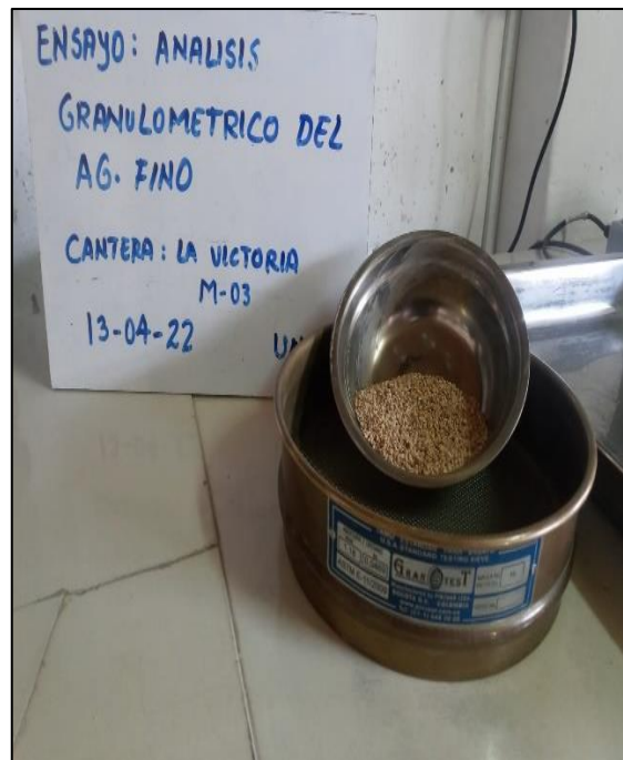
Foto N°04: granulometría del agregado fino.
