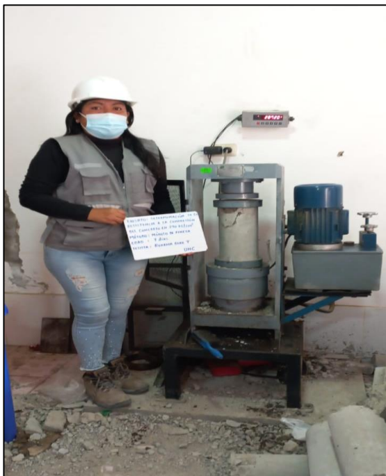
Foto N°27: determinación de la resistencia 210 kg/cm 2 método MÓDULO DE FINEZA 7,14 y 28 días.
