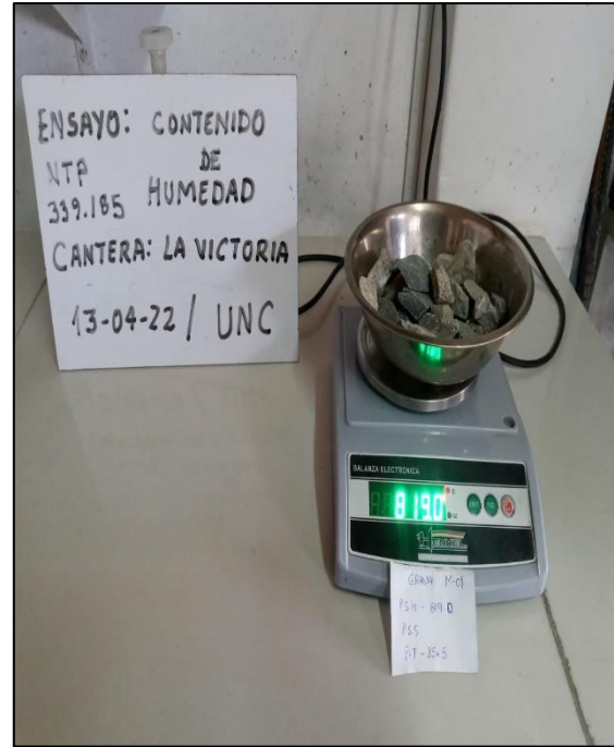
Foto N°06 selección de las muestras para el ensayo de contenido de humedad del agregado grueso.
