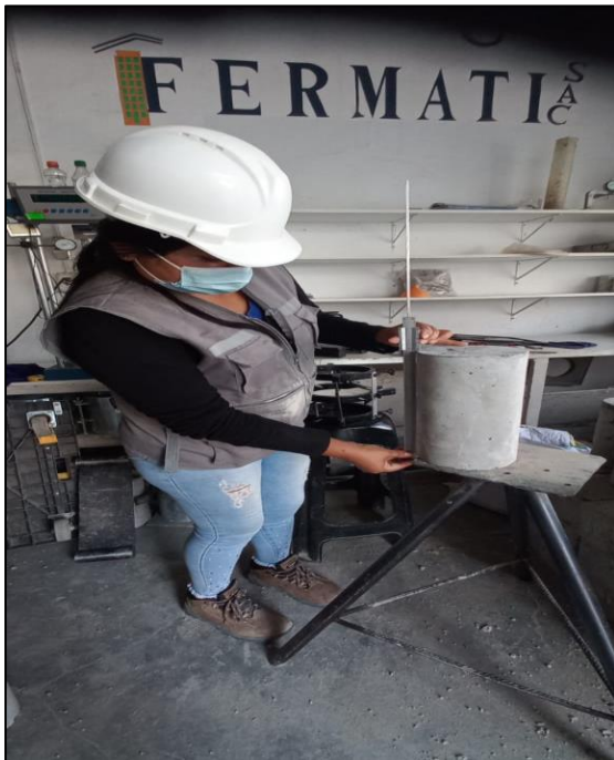
Foto N°23: se mide la longitud de la probeta antes de su rotura.
