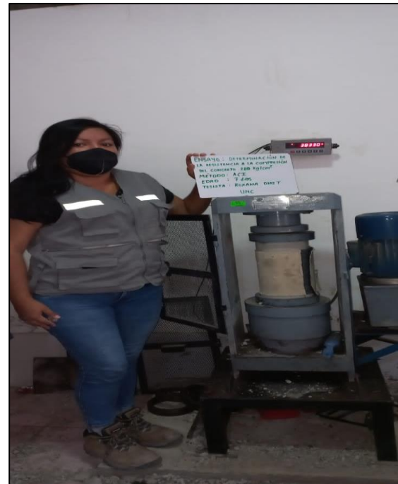
Foto N°28: determinación de la resistencia 280 kg/cm 2 método ACI 7,14 y 28 días.
