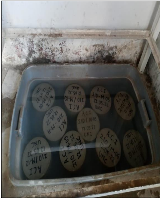
Foto N°21: se realiza el curado de los especímenes de concreto.
