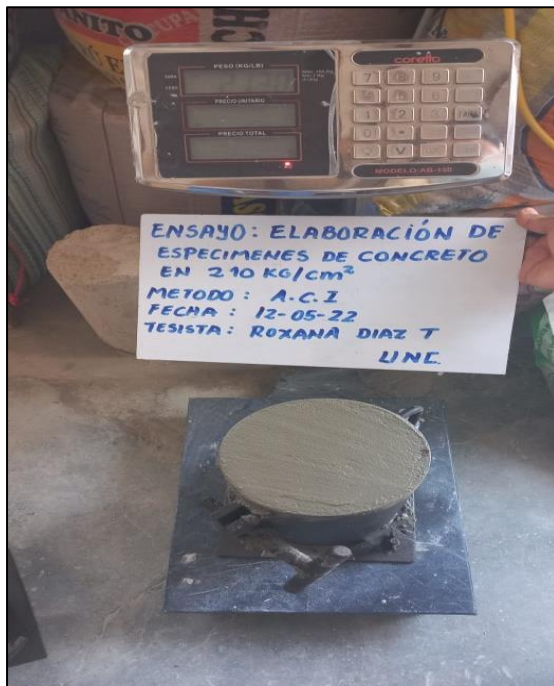
Foto N°19: elaboración de 30 probetas por método y para cada resistencia.
