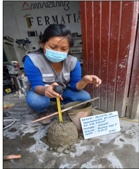
Foto N°18: se procede con la prueba de asentamiento del concreto por método y para cada resistencia.
