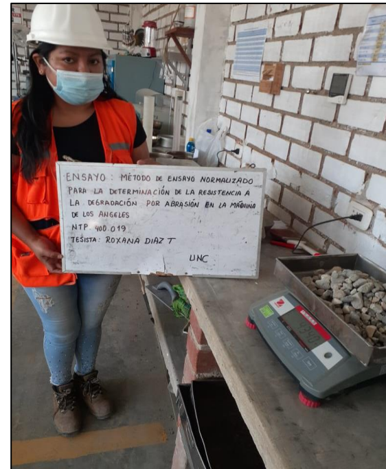
Foto N°16: se procede a pesar la muestra sacada de la máquina de los ángeles para el cálculo del desgaste.
