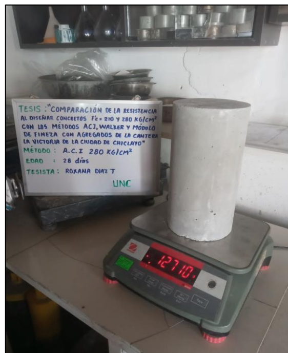
Foto N°24: se procede con el peso del concreto en estado endurecido.
