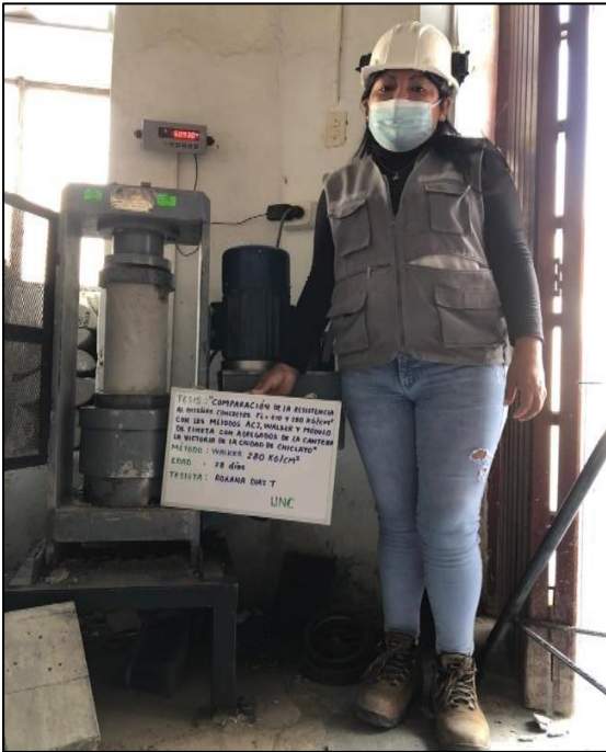
Foto N°29: determinación de la resistencia 280 kg/cm 2 método WALKER 7,14 y 28 días.
