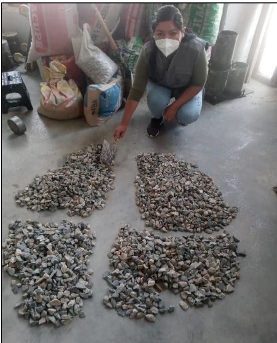
Foto N°03: cuarteo del agregado grueso para realizar su granulometría.
