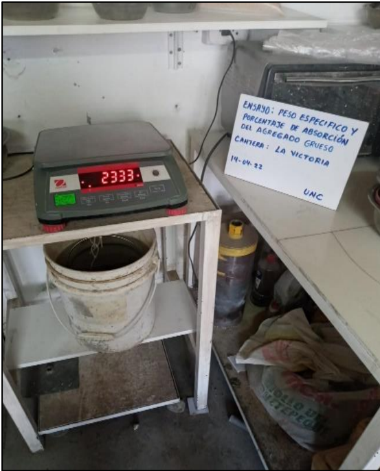
Foto N°13: peso de la muestra con superficie seca para realizar el ensayo del peso específico y absorción del agregado grueso.
