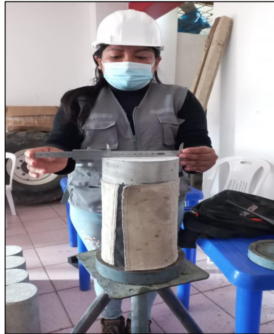
Foto N°22: se mide el diámetro de la probeta antes de su rotura.
