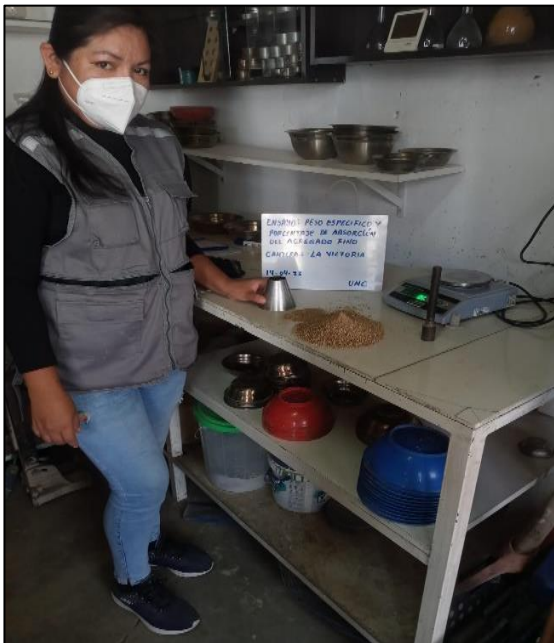
Foto N°09: se coloca la muestra en el molde para el ensayo del peso compactado del agregado fino, se compacta en 1/3 por capa y se enrasa con la barra compactadora.
