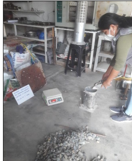
Foto N°08: se coloca la muestra en el molde para el ensayo del peso suelto del agregado grueso.
