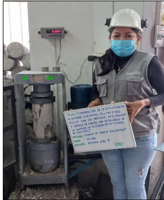
Foto N°30: determinación de la resistencia 280 kg/cm 2 método MÓDULO DE FINESZA 7,14 y 28 días.
