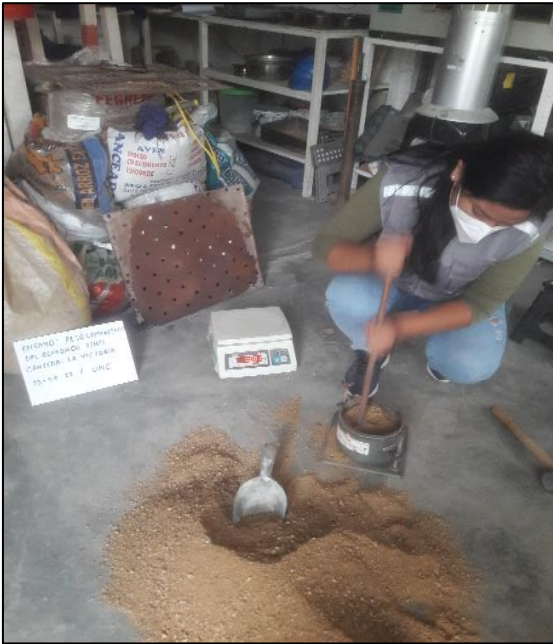
Foto N°09: se coloca la muestra en el molde para el ensayo del peso compactado del agregado fino, se compacta en 1/3 por capa y se enrasa con la barra compactadora.
