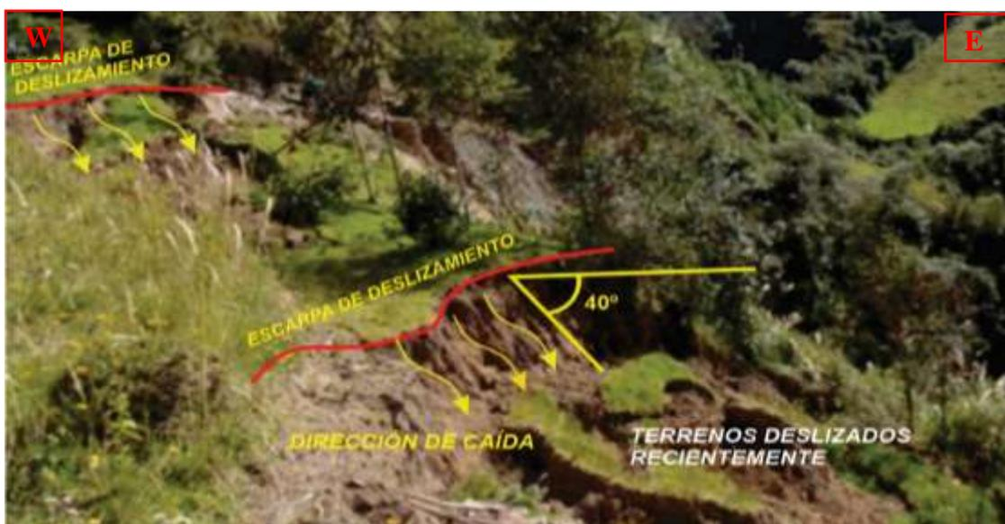
Figura 25. Deslizamiento RM-02. Se observa una escarpa de deslizamiento. La cara del talud es de  $40^\circ$  aproximadamente. Coordenadas UTM. N: 9217293 E: 769415.
