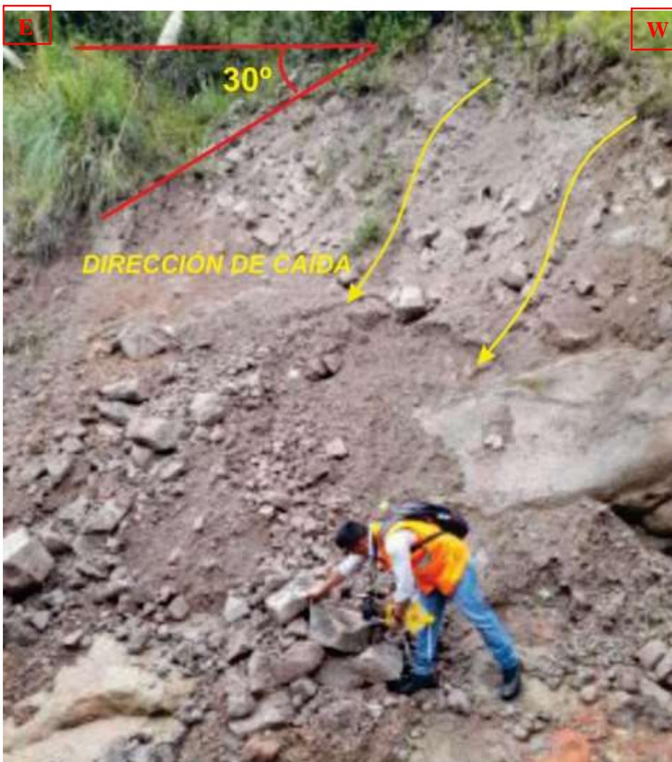
Figura 26. Movimiento de masa RM-06. Corresponde a caída de rocas. Se observan los fragmentos redondeados de las tobas traquíticas. En el centro poblado la Ramada. Coordenadas UTM. N: 9216491 E: 769940.
