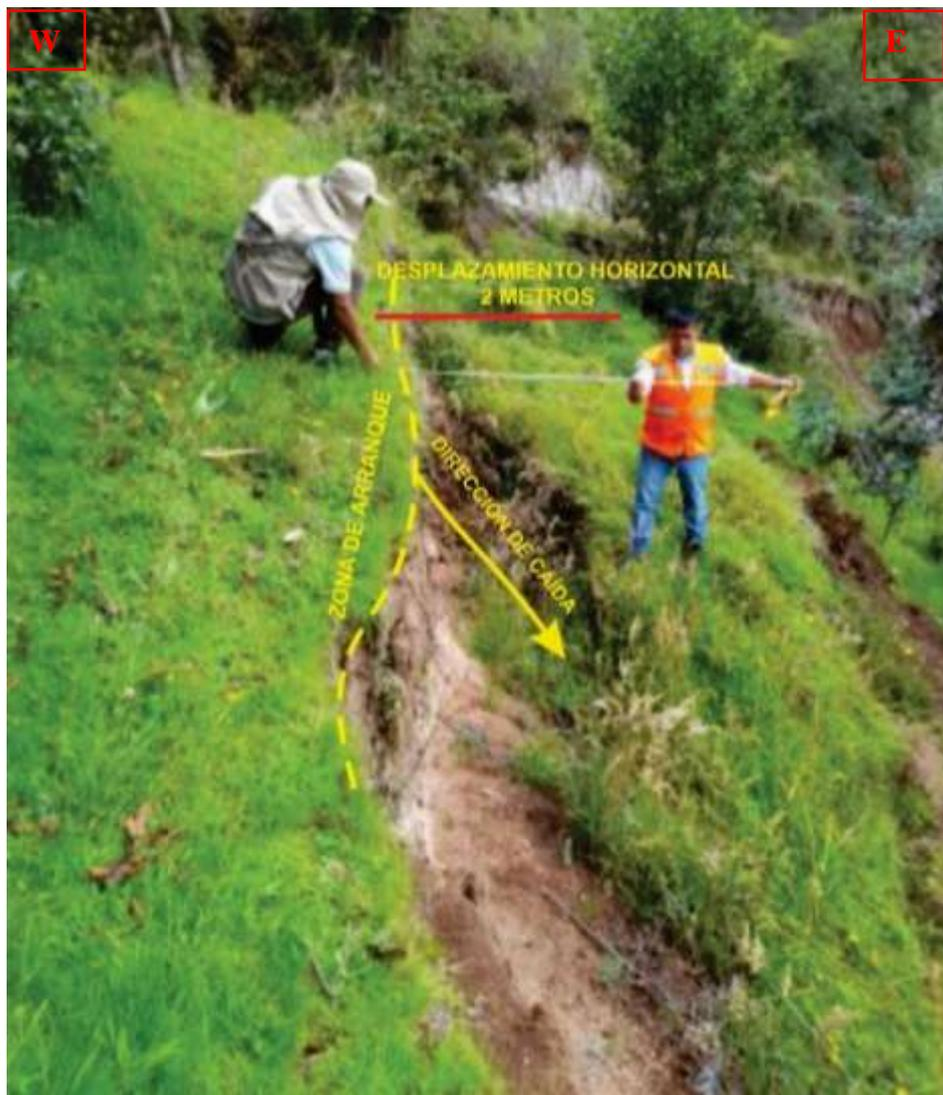
Medición del desplazamiento de terreno por deslizamiento en depósito. Coordenadas UTM. N: 9217750 E: 769092
