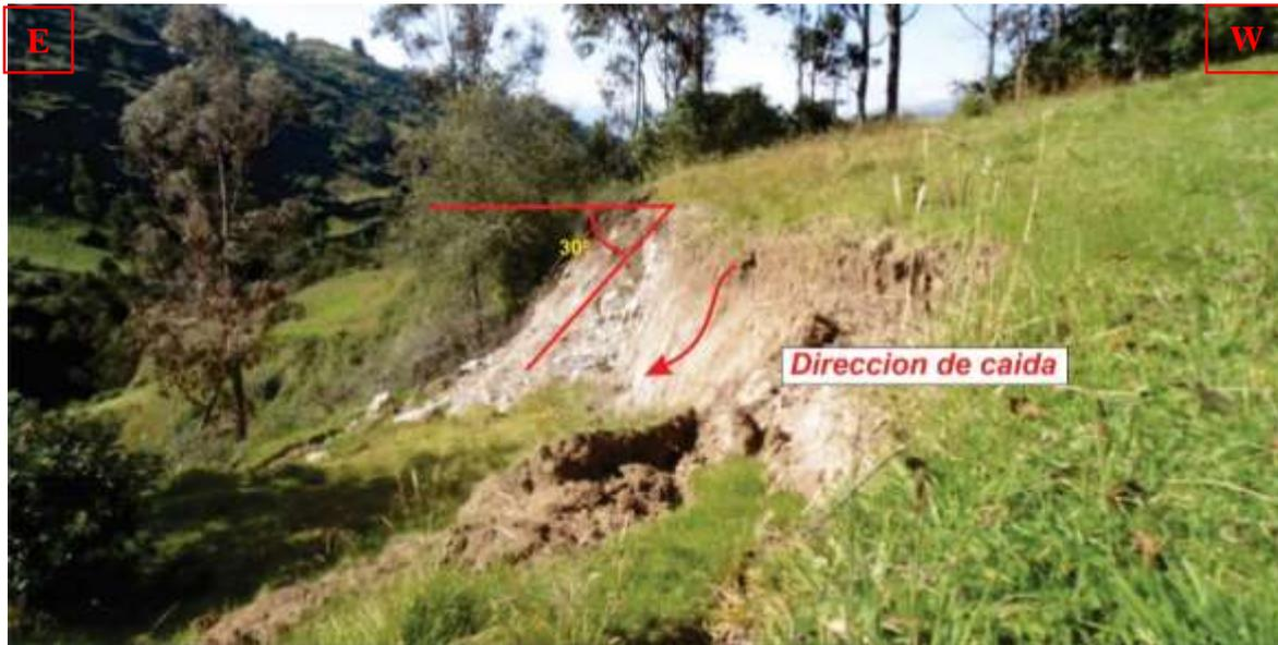
Figura 24. Deslizamiento RM-01. Se observa escarpa de falla, es un talud inestable, el deslizamiento presenta una matriz arcillosa con clastos de roca blanda en el centro poblado La Ramada. Coordenadas UTM. N: 9217293 E: 769415.
