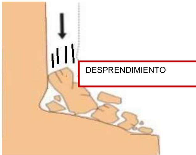
Figura 2. Esquema de caída de rocas
