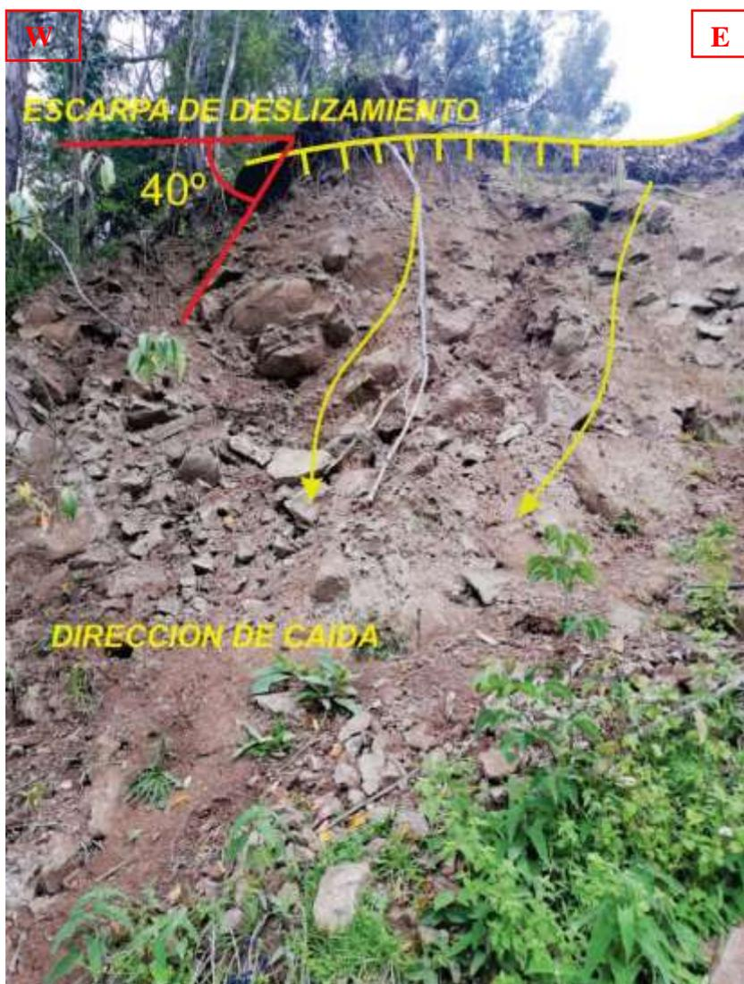
Figura 27. Movimiento de masa RM-07. Corresponde a caída de clastos de rocas. Se observan los fragmentos angulosos de las tobas traquiandesíticas. Coordenadas UTM. N: 9218322 E: 769486 (Ver Ficha N°02)
