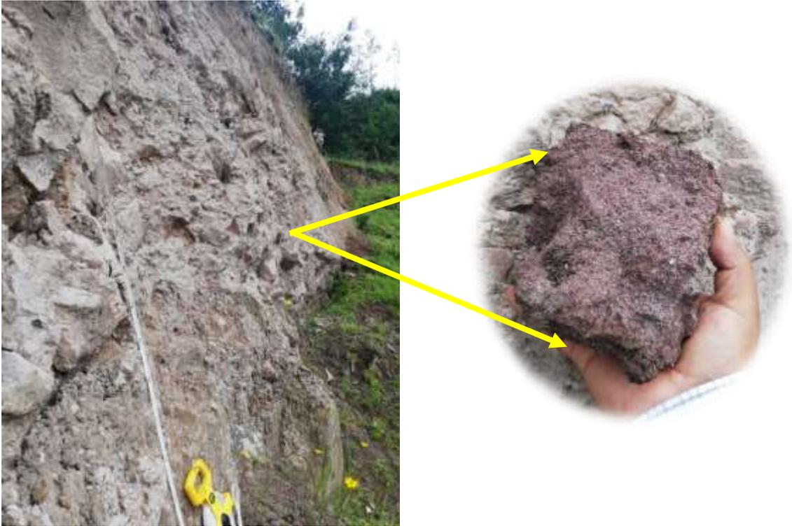
Figura 16. Afloramiento de roca volcánica, toba dacítica, que pertenece a la Formación Porculla. Coordenadas UTM N:9216748 E:769418. (Ver ficha 01)
