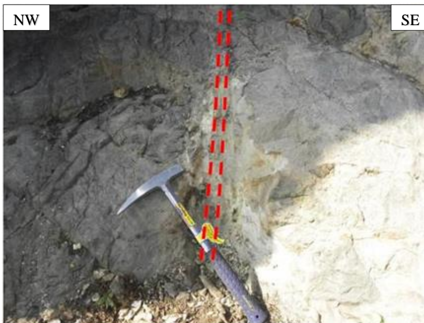
Figura 3.19. Veta de magnetita con alteraciones de hematita, con orientación Az = 255° y Bz = 78°NW, con espesor 2 a 5 cm. emplazado en roca caja de granito, englobando xenolitos diorita.
