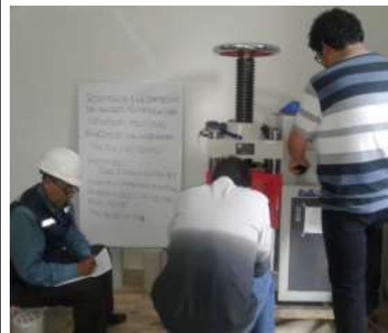
Figura 194. Ensayo a compresión axial de muestras con diferentes relaciones A/C.
