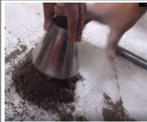
Figura 185. Ensayo de determinación de la condición saturada superficialmente seca (SSS) de la arena para el ensayo de peso específico y absorción.
