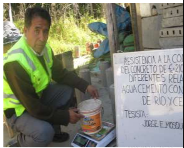
Figura 186. Peso de materiales de acuerdo a dosificación.
