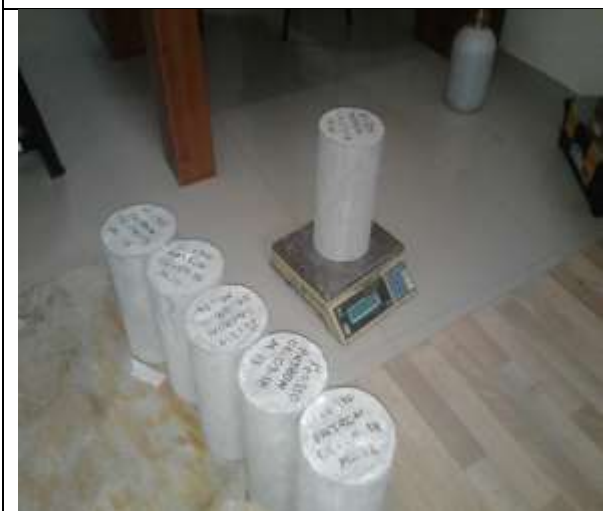
Figura 193. Registro del peso de probetas cilíndricas de concreto, antes del ensayo.
