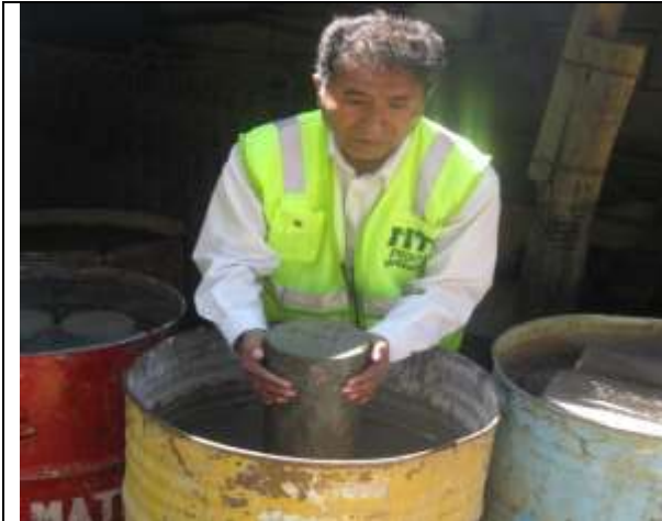
Figura 191. Curado de muestras en inmersión en agua.
