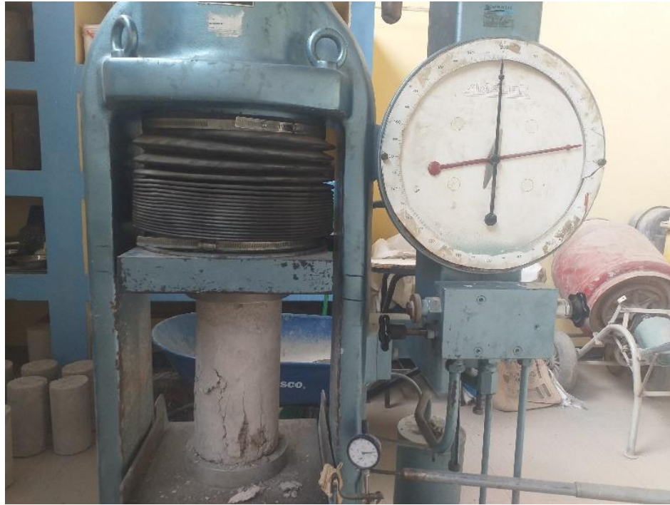
Fotografía N°19: Rotura de probetas de concreto compactado en máquina de compresión
