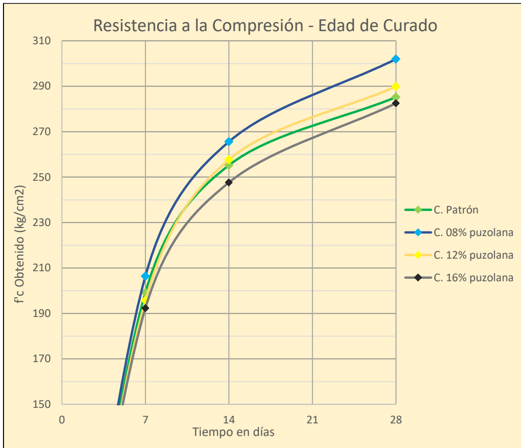
Figura N°18: Resistencia a la compresión – Edad de Curado (Diag. Líneas) Fuente: Elaboración Propia
