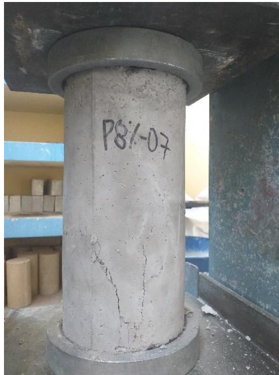
Fotografía N°18: Rotura de probetas – Falla tipo 2
