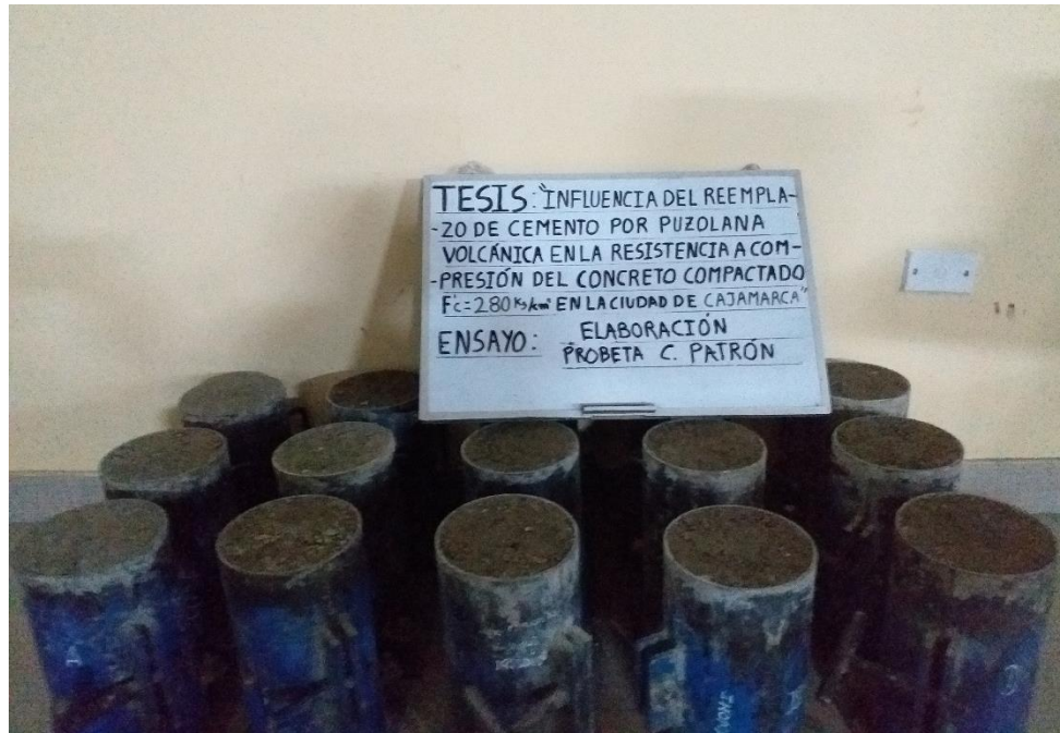
Fotografía N°15: Probetas cilíndricas de concreto compactado
