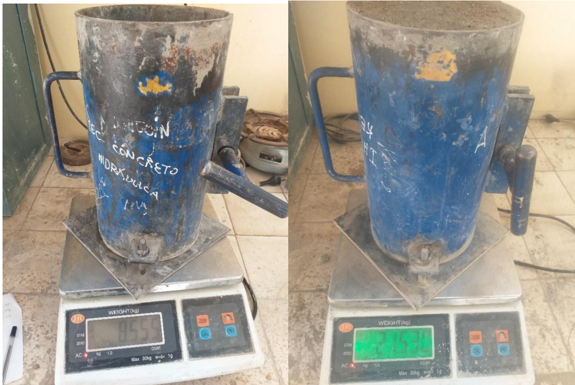
Fotografía N°16: Peso de molde de probetas para determinar el peso unitario del concreto fresco
