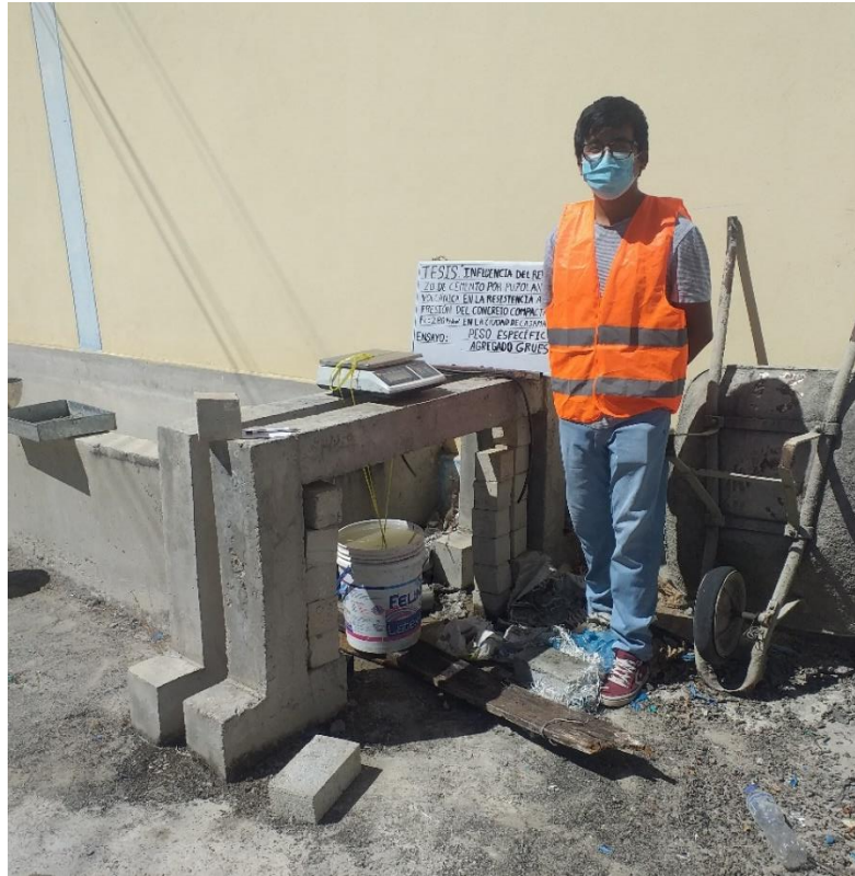
Fotografía N°07: Ensayo de peso específico de agregado grueso
