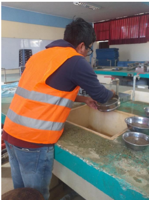
Fotografía N°05: Ensayo para determinar el material que pasa por el tamiz N°200
