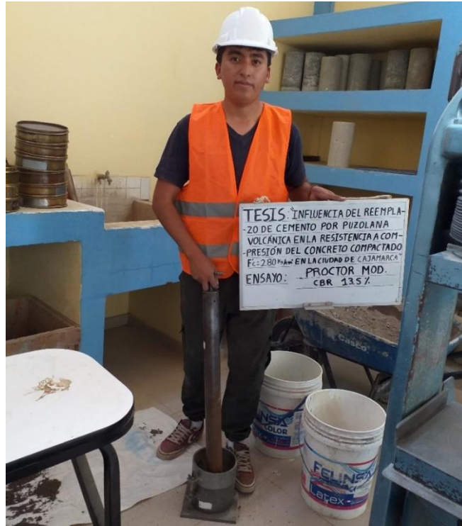
Fotografía N°11: Proctor modificado con el 13.50% de cemento
