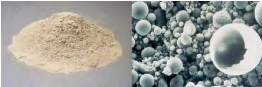
Figura N°05: Ceniza volante y micrografía de partículas de ceniza volante (aumento 1000X)
