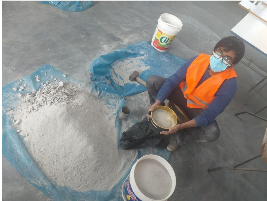
Fotografía N°09: Tamizado de roca traquita – puzolana volcánica
