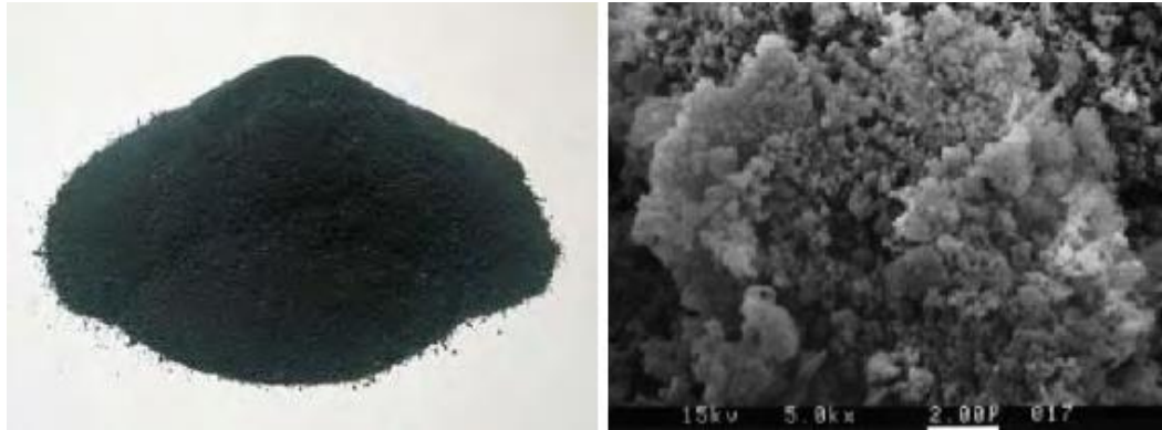
Figura N°06: Vista de la microsílíce y su micrografía de partículas (aumento 20000X)
