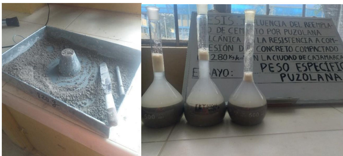
Fotografía N°06: Ensayo de peso específico de agregado fino y puzolana
