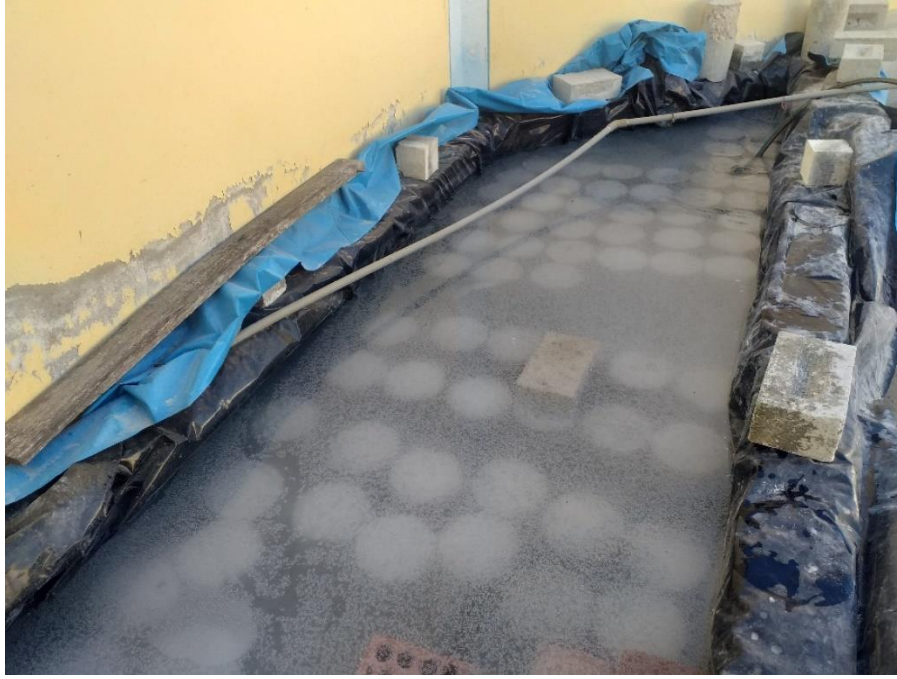
Fotografía N°17: Curado de probetas en pozo recubierto por plástico
