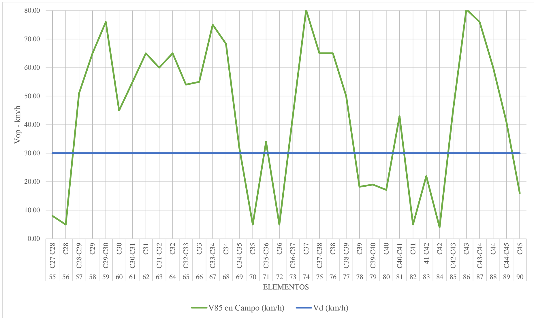
Figura N° 16: Perfil de velocidad del tramo 2+000 km – 4 + 000km.
