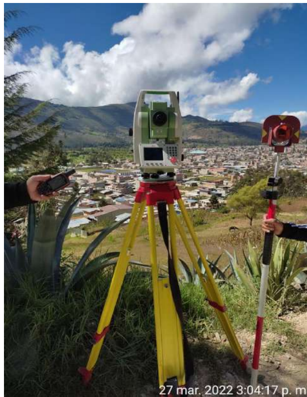
Fotografía N° 1: Estación total TS-09, GPS y prisma, usados para el levantamiento topográfico.
