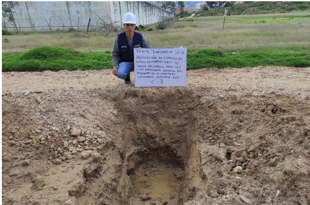
Figura 14: Extracción de material de calicata C03 para la elaboración de tesis
