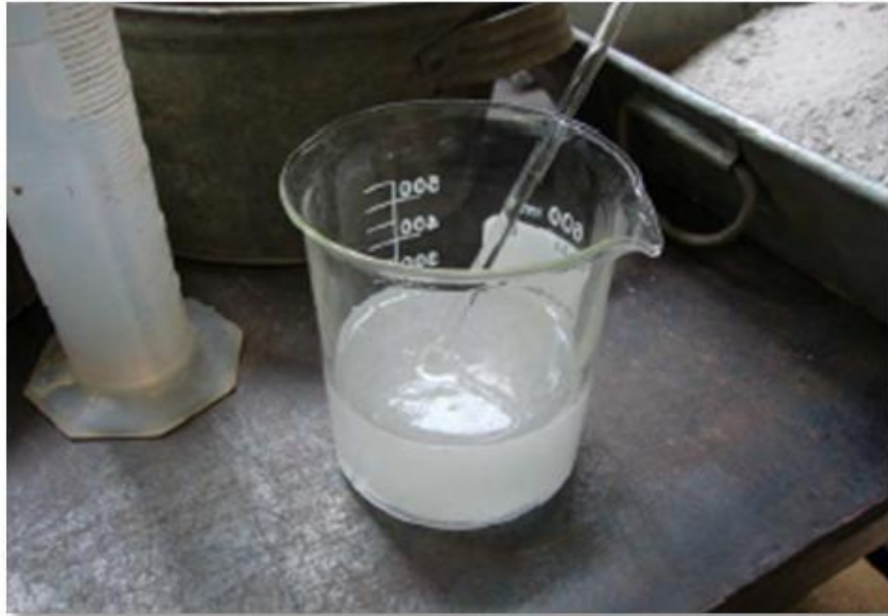
Figura 4: Aplicación de cloruro de sodio al suelo en salmuera Fuente: Roldan, 2010
