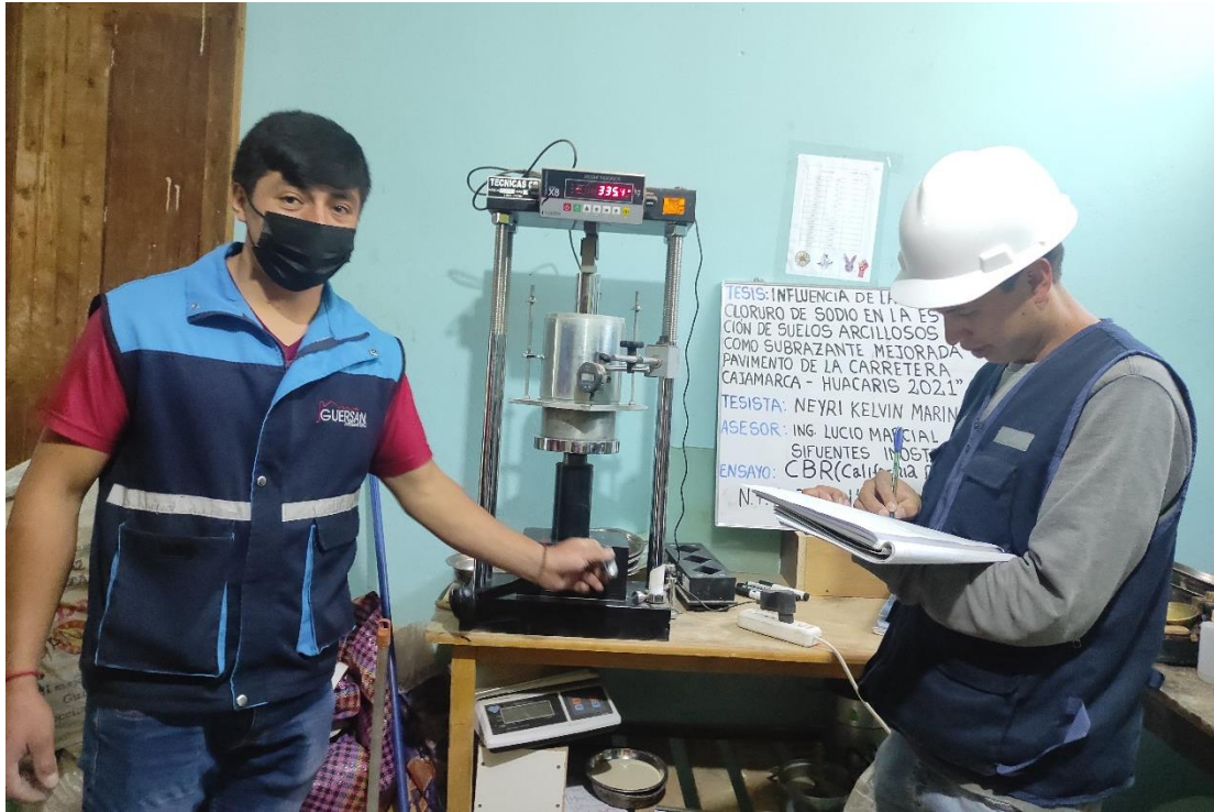
Figura 22: Ensayo de Carga-Penetración en el ensayo CBR
