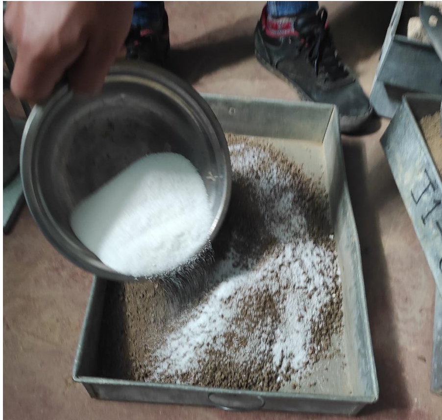
Figura 24: Adición de cloruro de sodio a la muestra patrón
