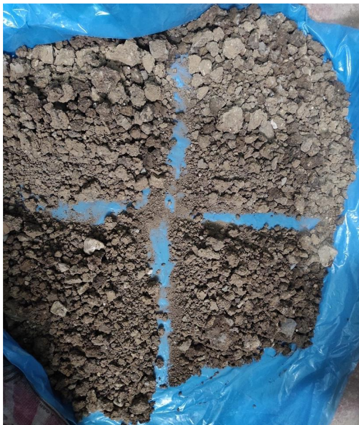
Figura 17: Cuarteo de material
