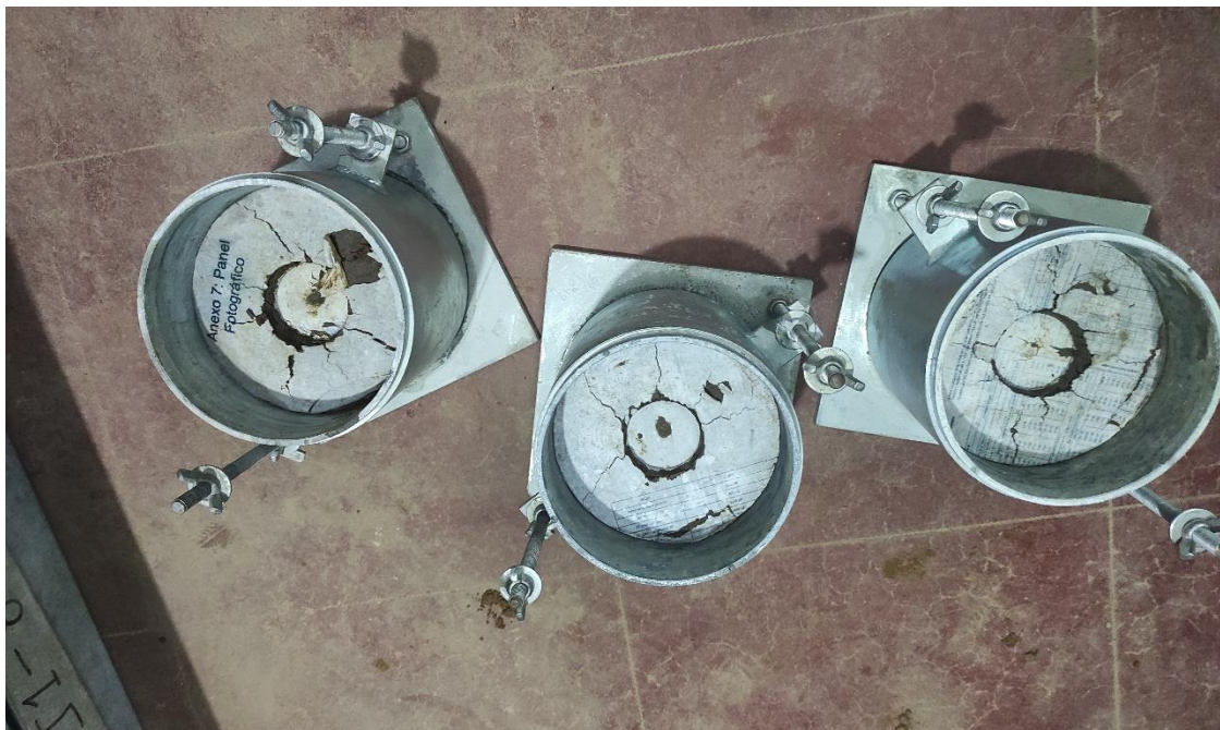
Figura 23: Muestra de suelo después de la prueba de carga-penetración
