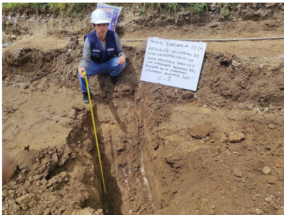
Figura 12: Extracción de material de calicata C01 para la elaboración de tesis
