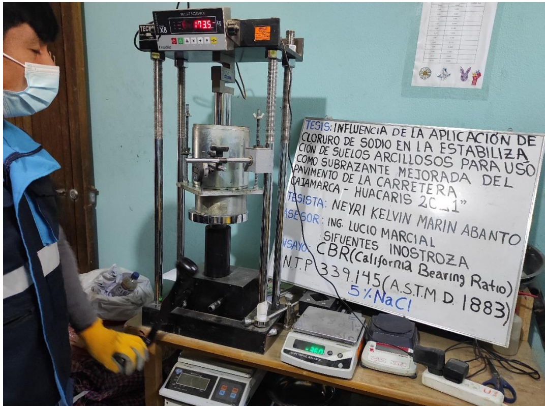
Figura 25: Ensayo de Carga-Penetración de la muestra de suelo al 5% de cloruro de sodio
