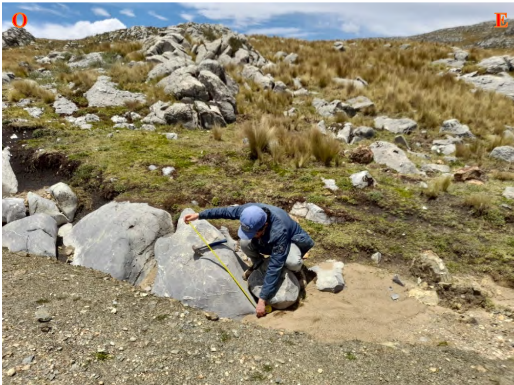
Figura 40. Medición de estrato grueso de caliza gris del Miembro Medio de la Formación Cajamarca.
