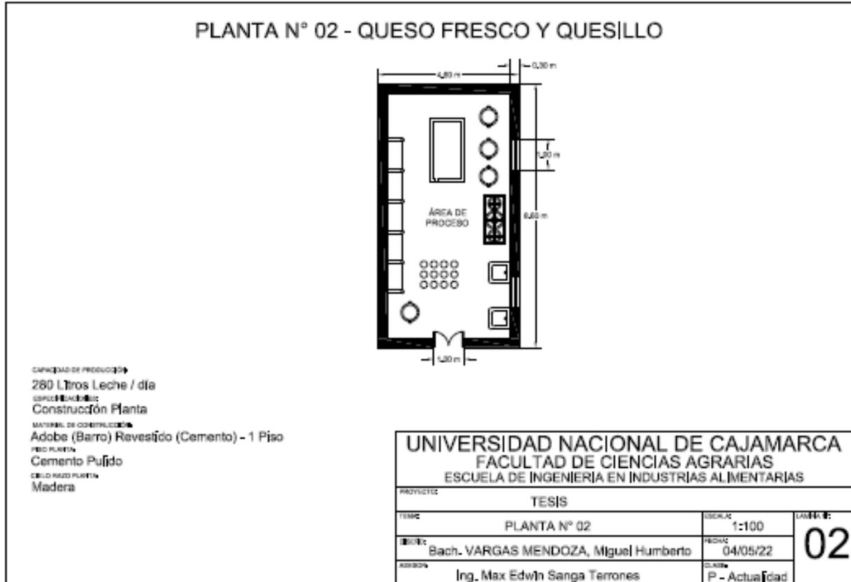
*Nota:* La figura muestra el plano de distribución del área de producción de la planta procesadora de queso fresco y quesillo.
