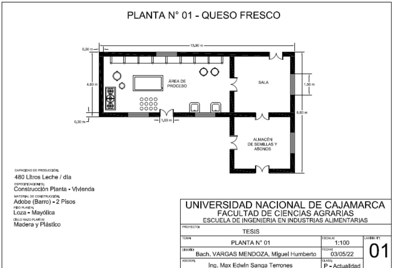
*Nota:* La figura muestra el plano de distribución del área de producción de la planta procesadora de queso fresco.
