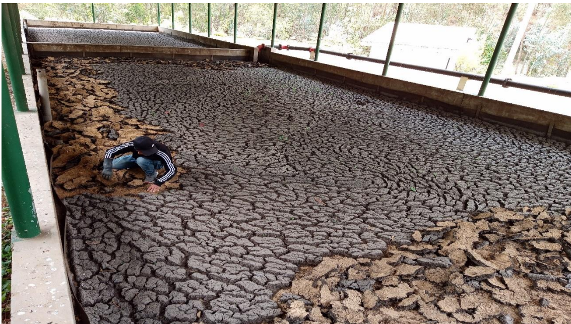
Figura 59: Proceso de deshidratación de los lodos
