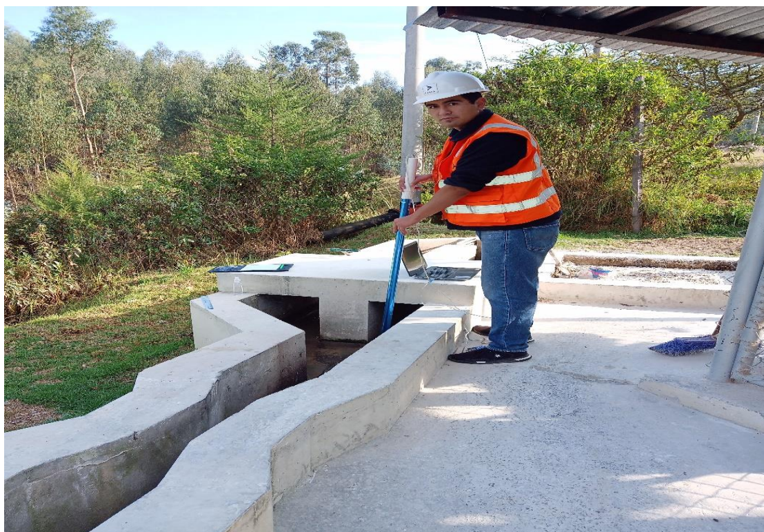
FOTOGRAFÍA N°08: Uso de correntómetro para determinar el caudal
