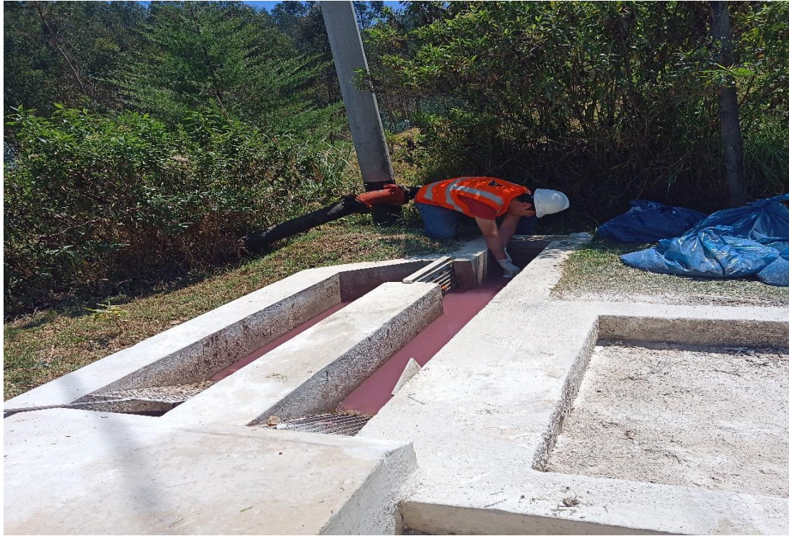
FOTOGRAFÍA N°01: Toma de muestra al inicio de la PTAR
