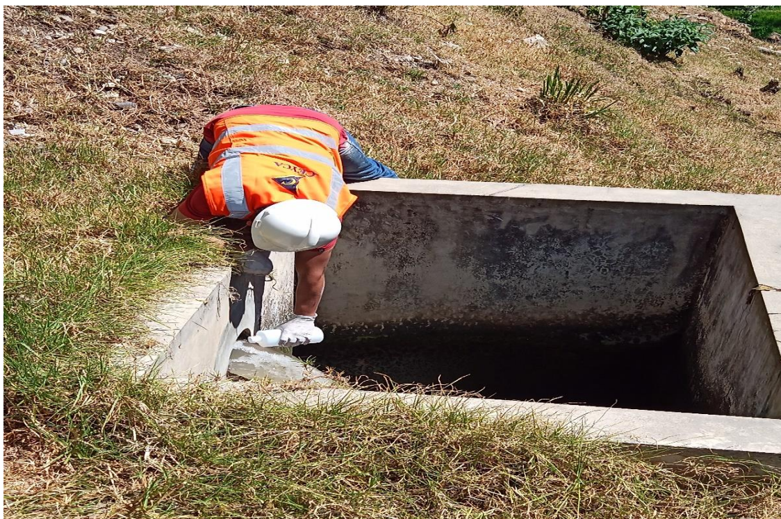
FOTOGRAFÍA N°05: Toma de muestra a la salida de la PTAR
