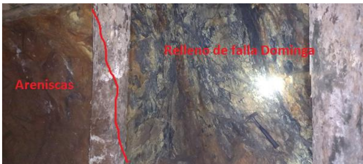
Figura 18. Falla Dominga, controladora de la mineralización de la Veta Lucerito.
