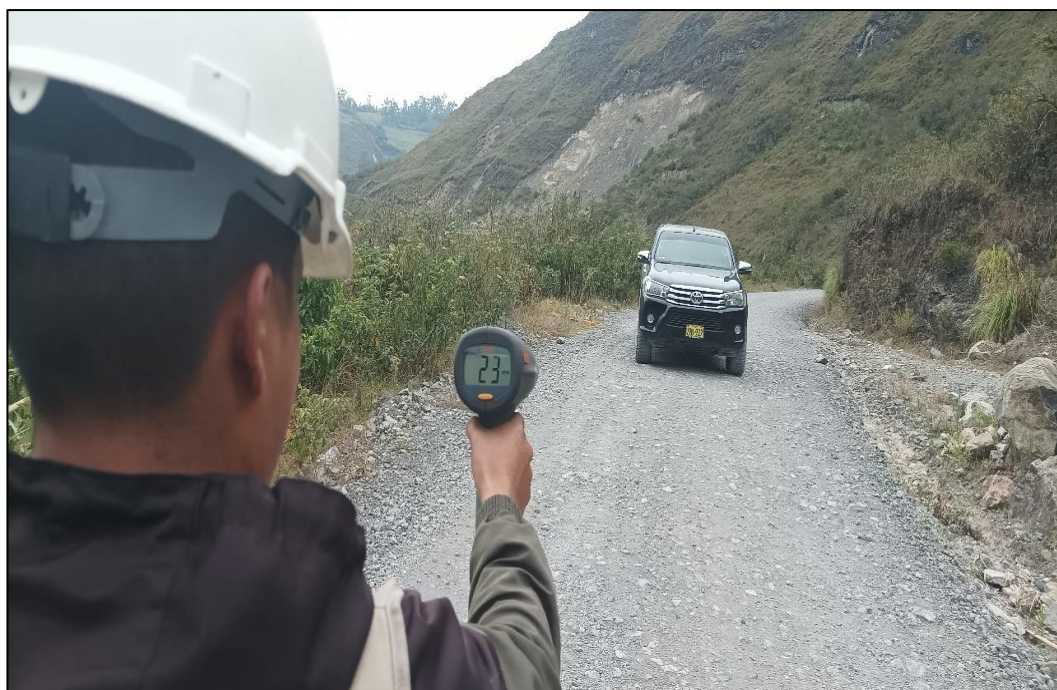
Figura N° 52. Medición de velocidades de operación en tramo recto.
