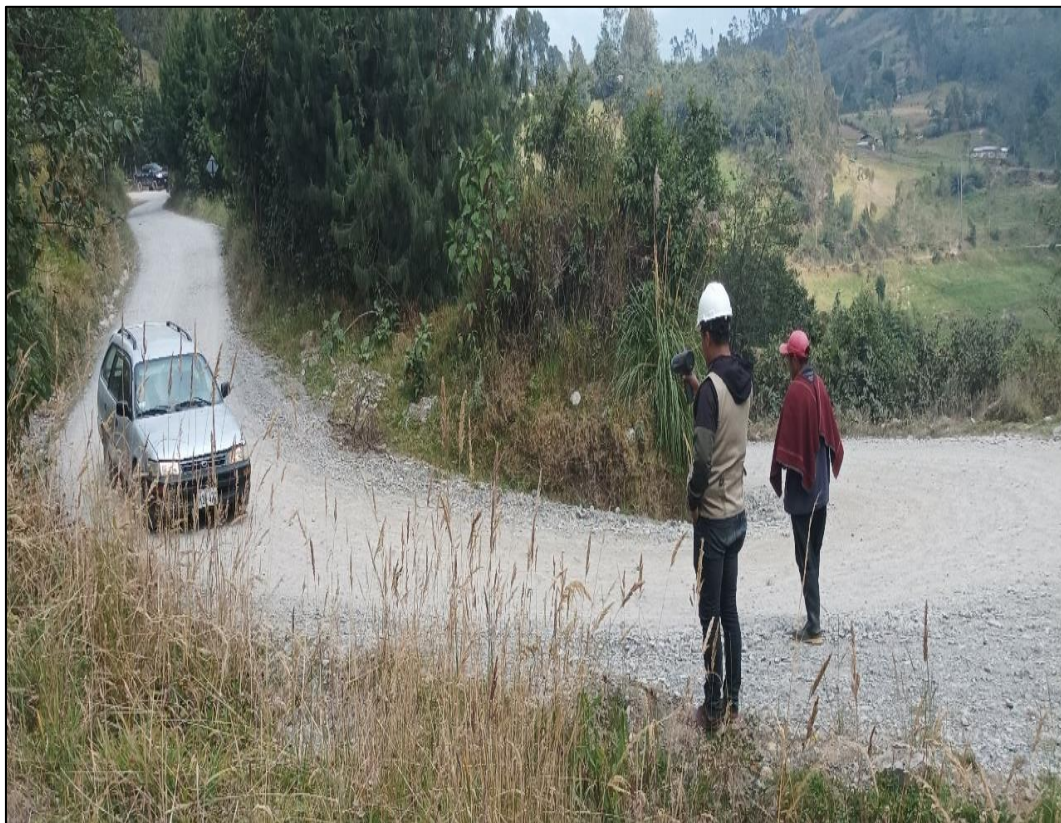
Figura N° 51. Medición de velocidades de operación en curva horizontal.
