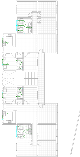
DESAGÜE SEGUNDO PISO - VIVIENDA Esc.1 : 360
