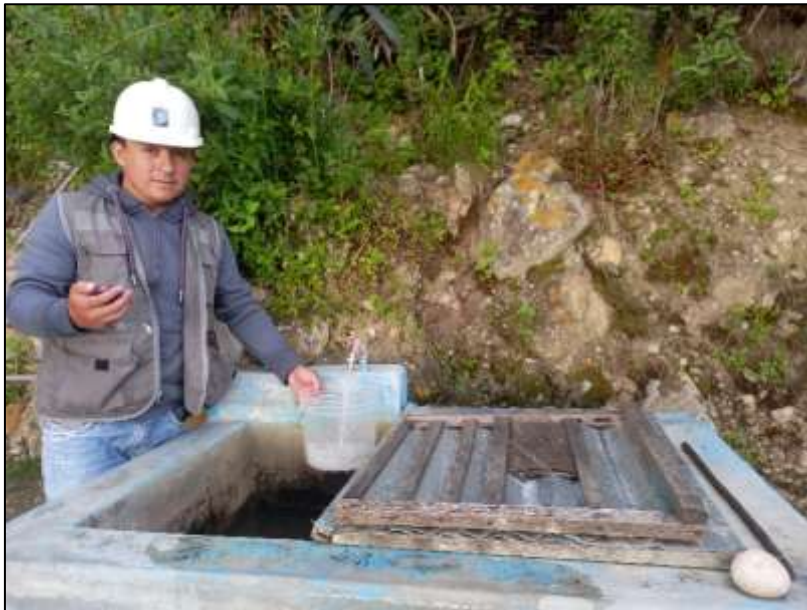
Figura N°2. Toma de medidas de caudal en el grifo de la V34.
