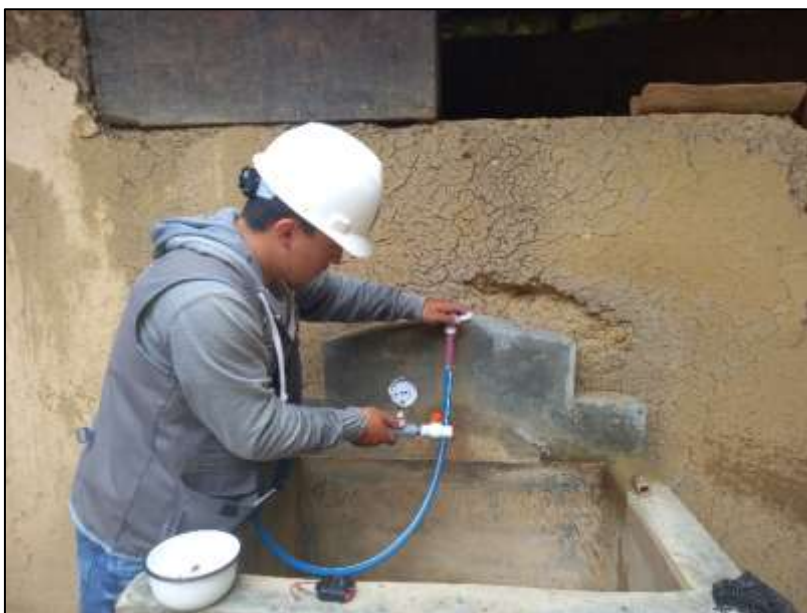
Figura N°2. Toma de medidas de presión en el grifo de la V14.
