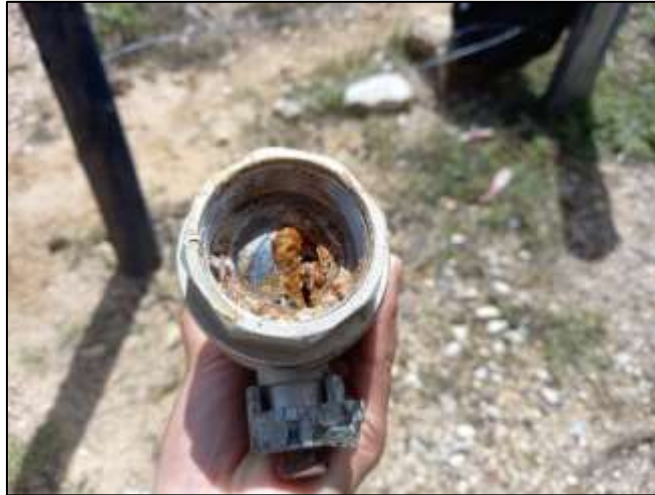
Figura N°13. Obstrucción de la llave por la acumulación de sarro.
