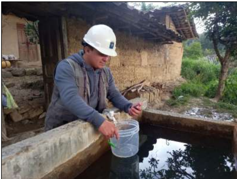
Figura N°2. Toma de medidas de caudal en el grifo de la V34.
