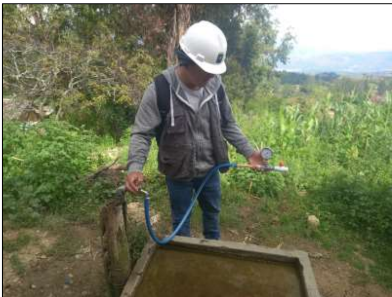
Figura N°2. Toma de medidas de presión en el grifo de la V14.
