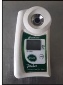
**Figura 8.** Refractómetro de bolsillo Marca ATAGO PAL-3.
