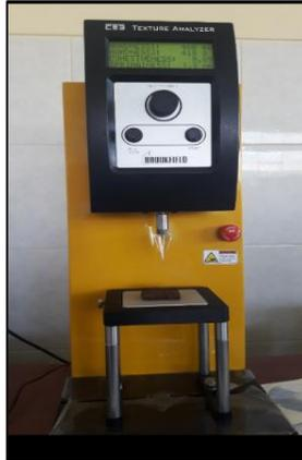
**Figura 11.** Texturómetro Marca BROOKFIELD CT3.
