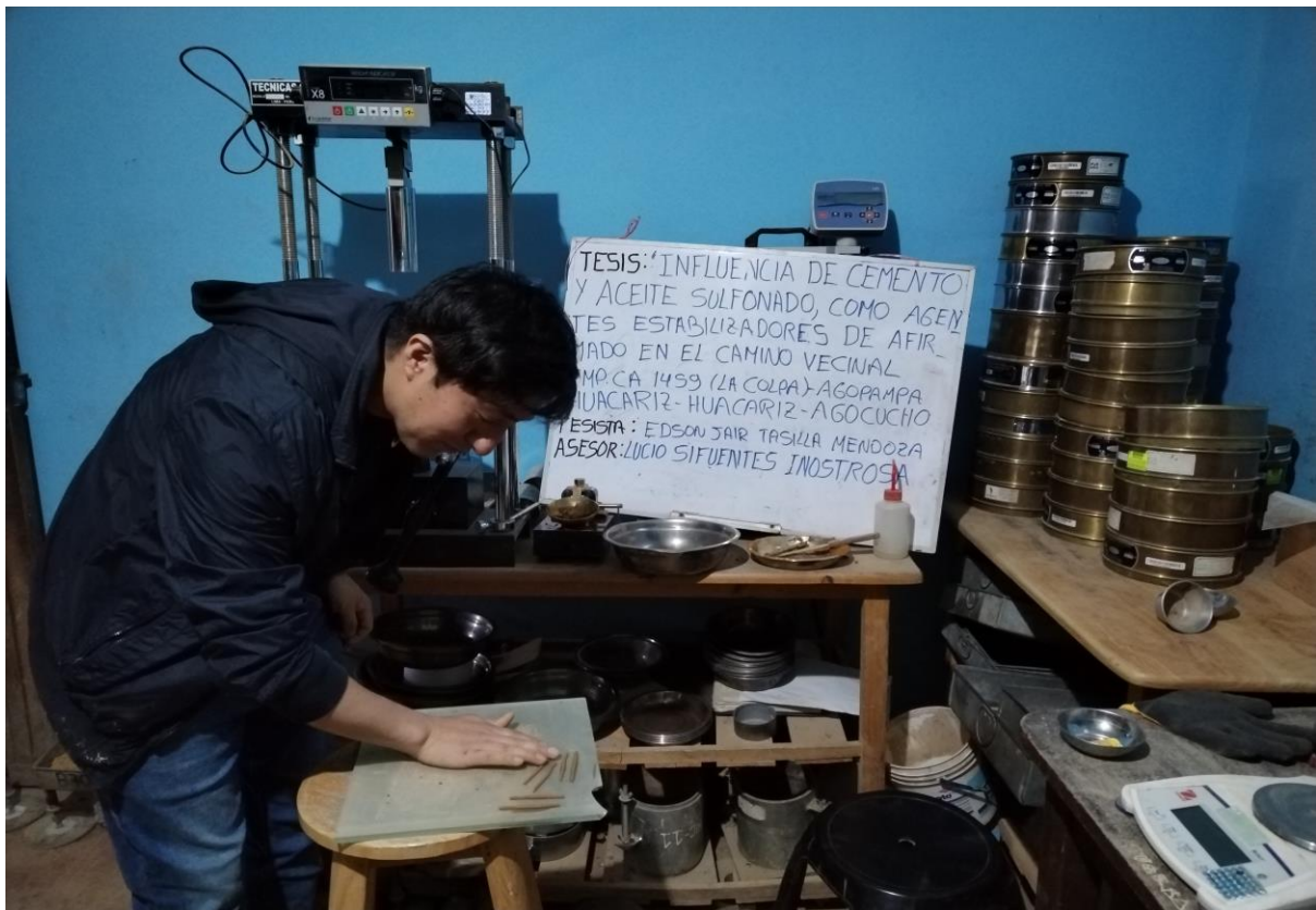
Figura 19: Ensayo de laboratorio – límites de Atterberg – límite plástico.
