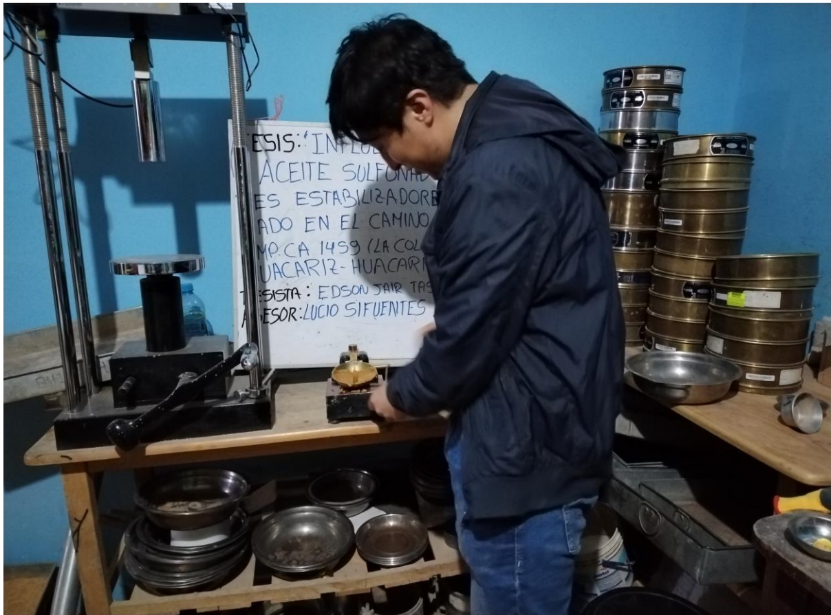
Figura 18: Ensayo de laboratorio – límites de Atterberg – límite líquido.
