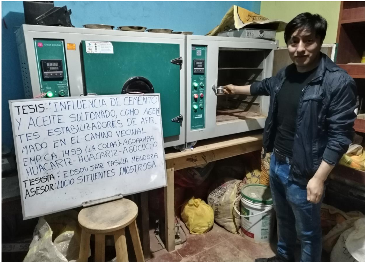
Figura 20: Ensayo de laboratorio – límites de Atterberg – límite plástico – muestras al horno.
