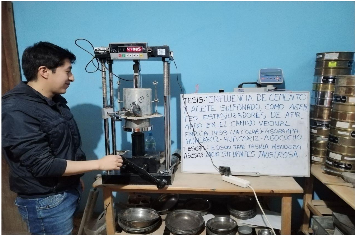
Figura 30: Ensayo de laboratorio – California Bearing Ratio CBR –carga penetración final.
