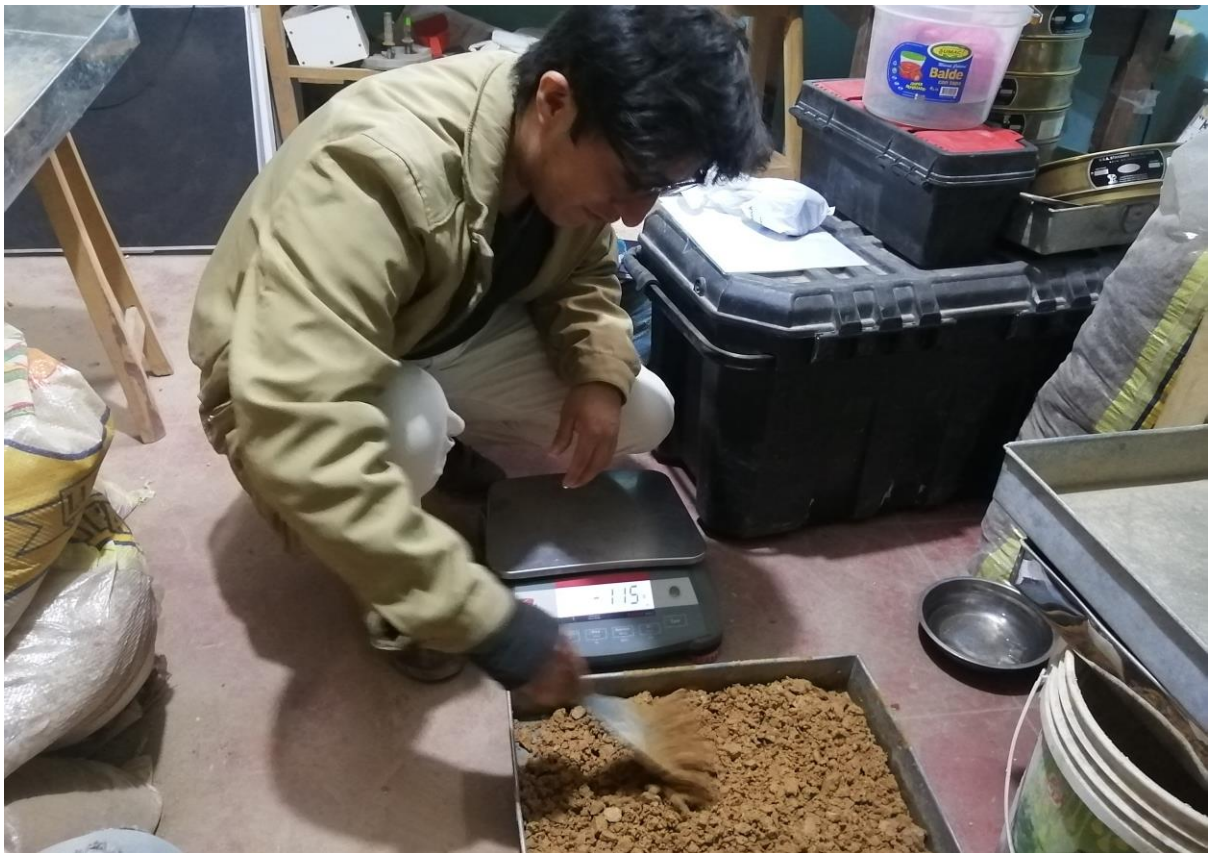
Figura 23: Ensayo de laboratorio – Proctor modificado – mezclado uniforme de muestra y agua.
