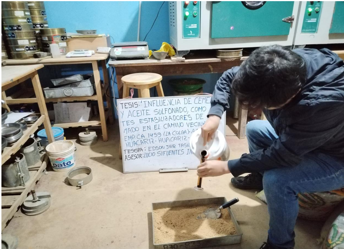
Figura 28: Ensayo de laboratorio – California Bearing Ratio CBR –preparación de la muestra con cemento y aceite.
