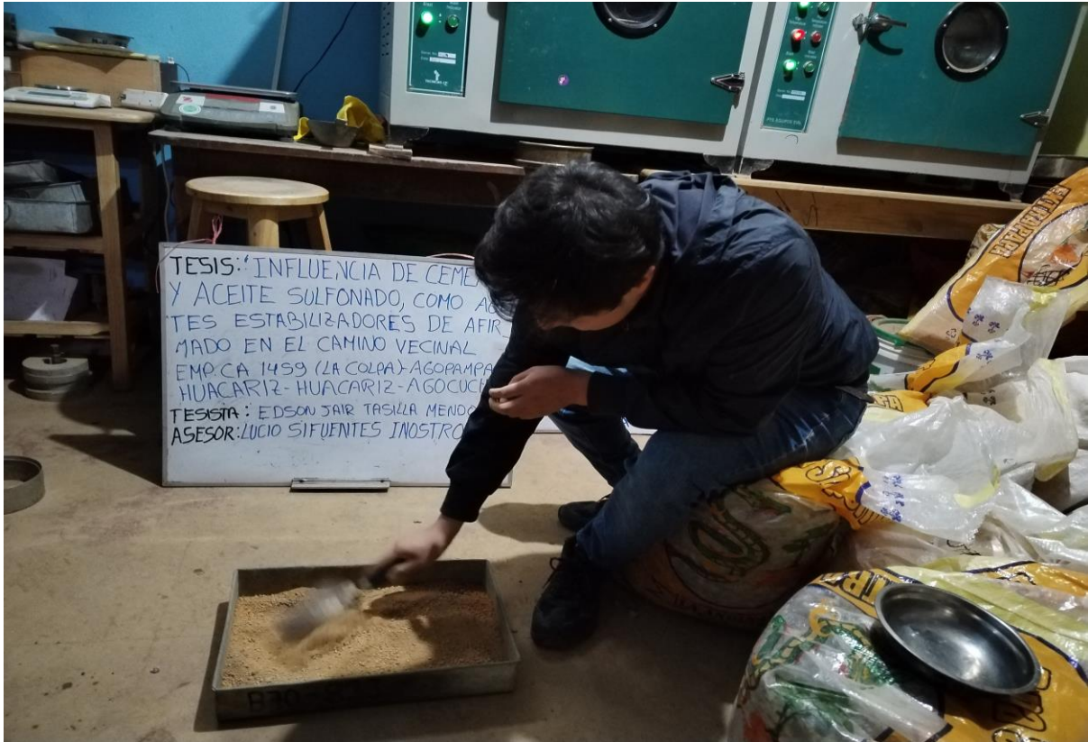
Figura 26: Ensayo de laboratorio – California Bearing Ratio CBR –preparación de la muestra sin aditivos.
