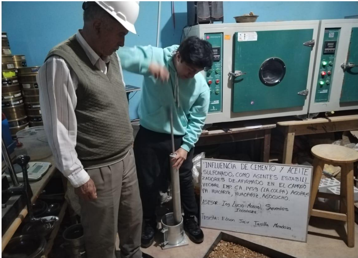
Figura 24: Ensayo de laboratorio – Proctor modificado – compactación por capas en el molde.
