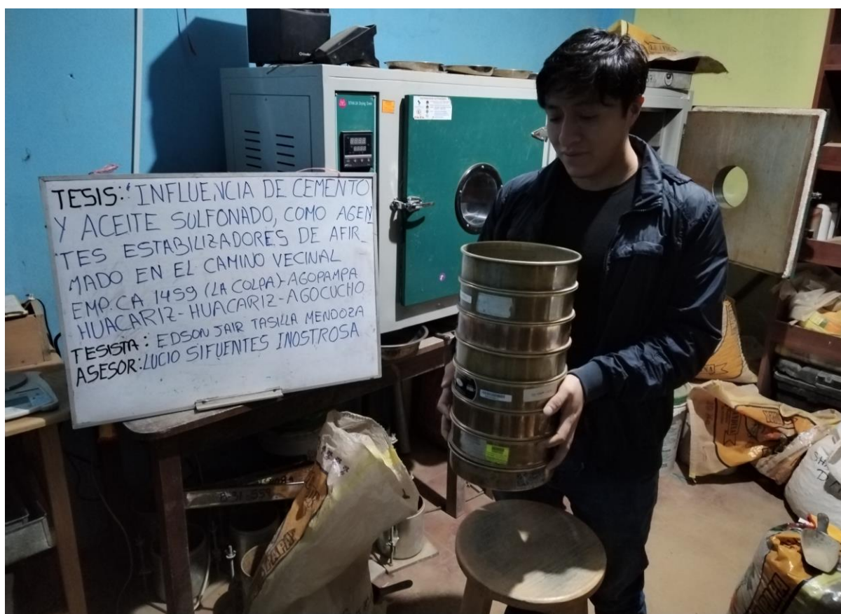
Figura 15: Ensayo de laboratorio – análisis granulométrico - tamizado.
