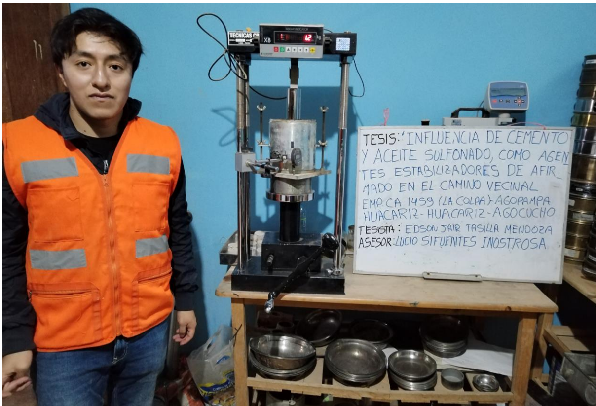
Figura 29: Ensayo de laboratorio – California Bearing Ratio CBR –carga penetración.
