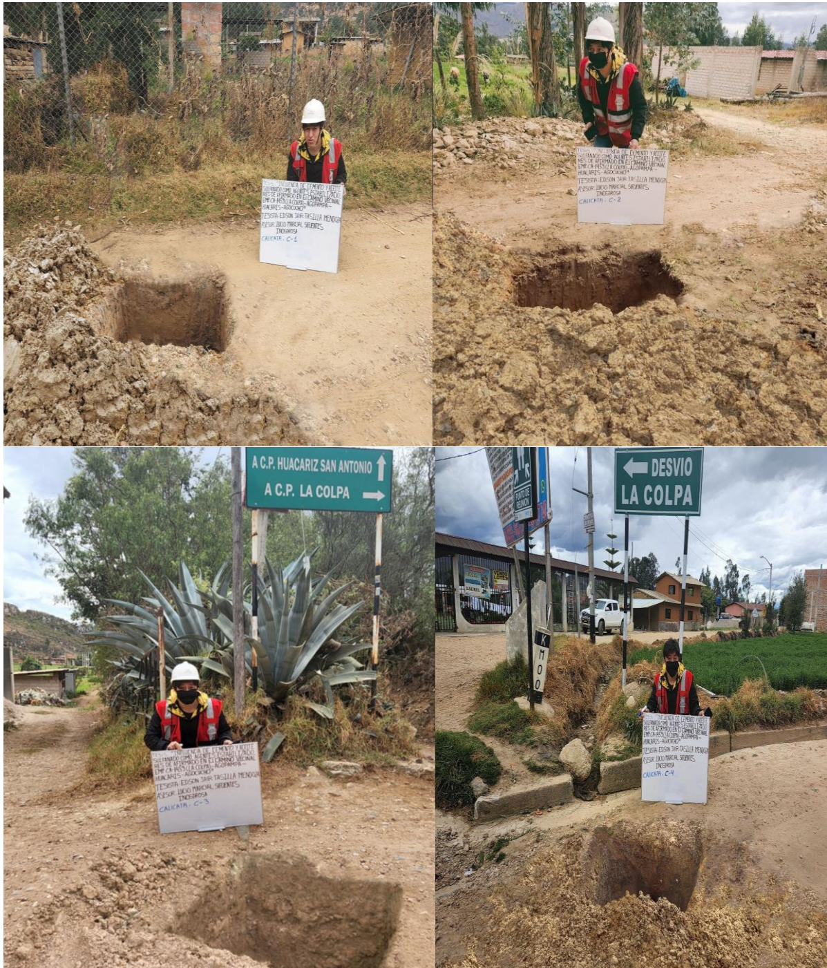
Figura 13: Calicatas en el camino vecinal Emp CA 1459 (La Colpa)- Agopampa Huacariz, Huacariz- Agocucho.
