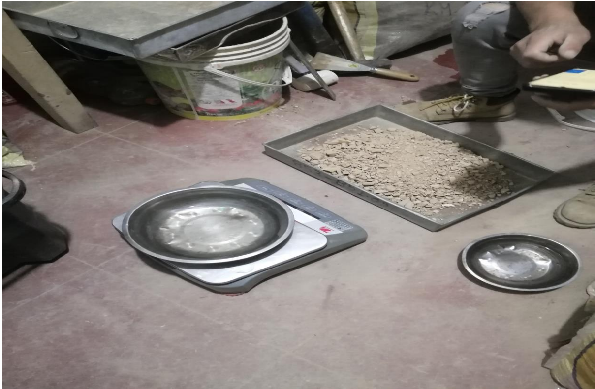
Figura 22: Ensayo de laboratorio – Proctor modificado – peso de agua usada.
