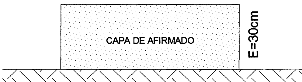
Figura 26: ESTRUCTURA DEL AFIRMADO.
