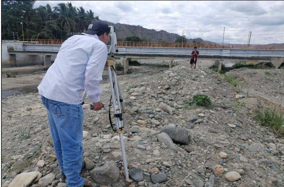
Figura 36. Levantamiento topográfico del cauce aguas abajo.
