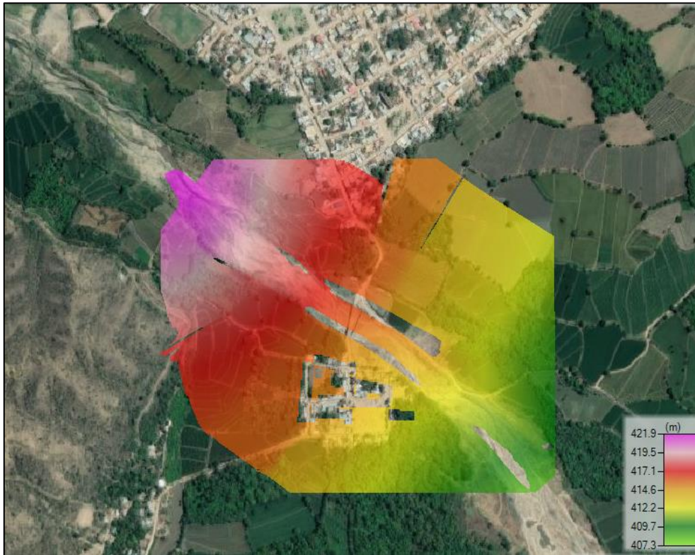
Figura 34. Resultado del modelo hidráulico en HECRAS-2D para un TR 200 años – Mapa de altura de cota de agua en m.
