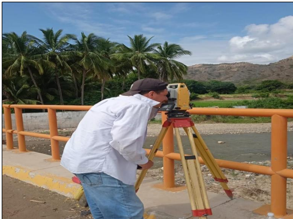
Figura 37. Levantamiento topográfico del cauce aguas arriba.
