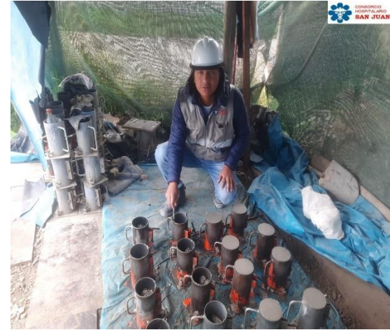
Fotografía N°12. Elaboración de testigos de concreto para cada elemento estructural.
