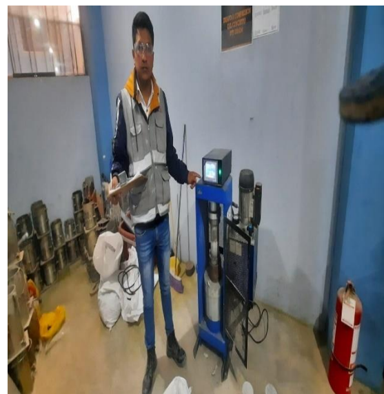
Fotografía N°32. Se registró la carga máxima en kN del testigo ensayado.
