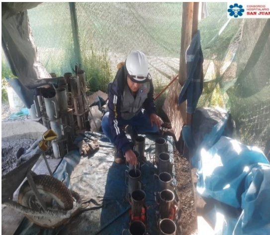
Fotografía N°11. Elaboración de testigos de concreto para cada elemento estructural.
