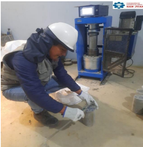
Fotografía N°31. Se midió el diámetro promedio del testigo de concreto para calcular su área y posteriormente realizar el ensayo para determinar su resistencia.
