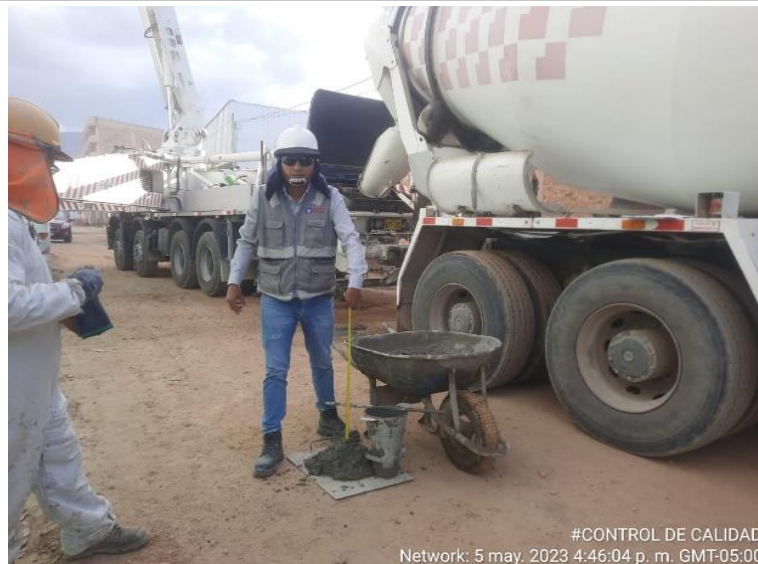
Fotografía N°01. Prueba de asentamiento antes del vaciado de los elementos estructurales.
