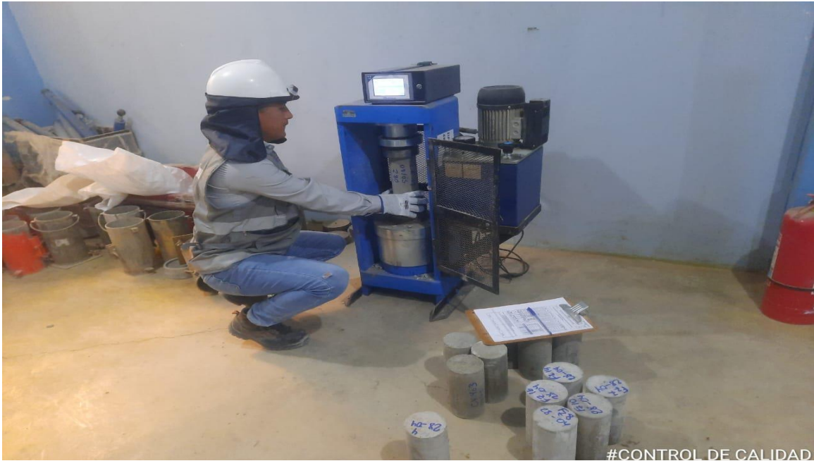
Fotografía N°30. Se realizaron los ensayos de compresión en los testigos de diferentes elementos, tanto a los 7, 14 como a los 28 días, con el fin de corroborar que la resistencia del concreto cumple con los requisitos establecidos en el expediente técnico.
