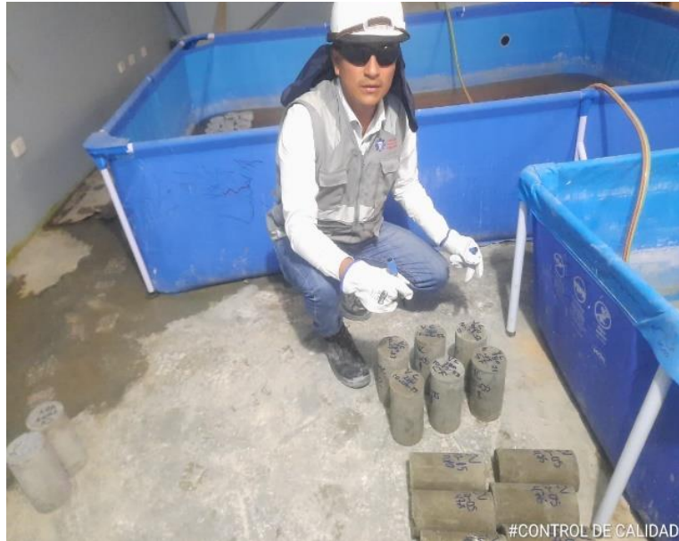
Fotografía N°29. Identificación de los testigos de concreto, los cuales fueron sometidos a un proceso de curado durante 7, 14 y 28 días y posteriormente se realizaron los ensayos de compresión.
