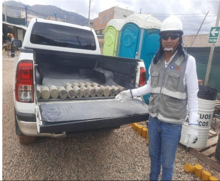
Fotografía N°28. Transporte de los testigos al laboratorio para su curado y posterior realización del ensayo de compresión.
