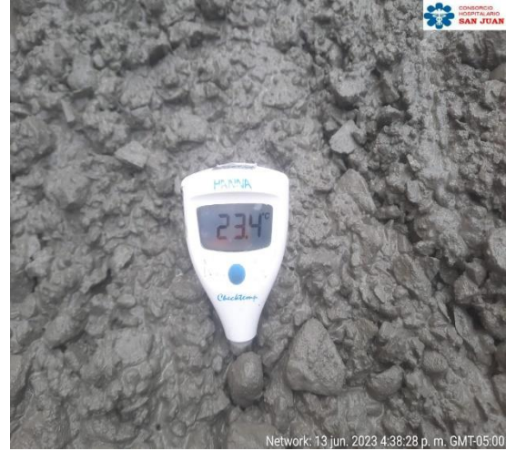
Fotografía N°06. Resultado de temperatura antes del vaciado del elemento estructural.
