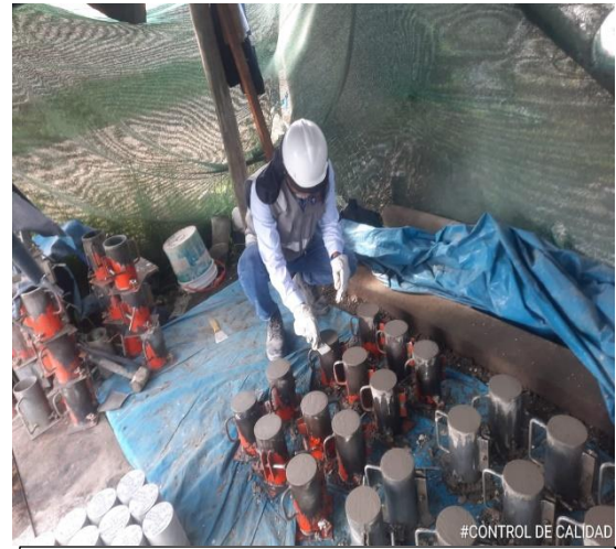
Fotografía N°10. Elaboración de testigos de concreto para cada elemento estructural.
