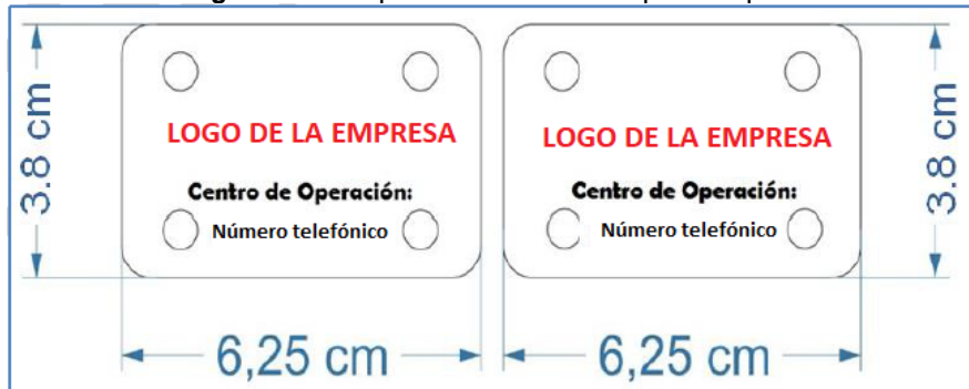
Figura 68: Etiqueta externa de Empalme tipo 1
