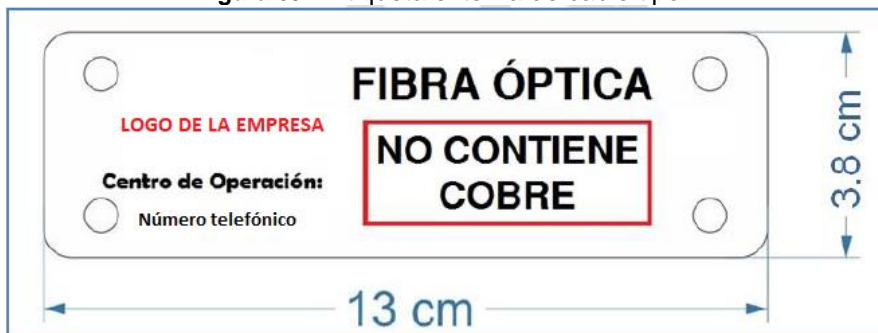
Figura 69: Etiqueta externa de cable tipo 2
