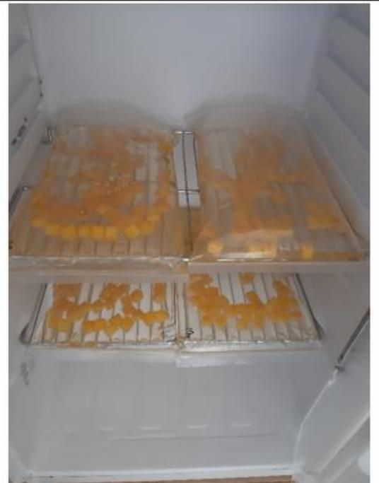
**Acondicionamiento de muestras deshidratadas por osmosis a temperatura constante de 20°C en incubadora**
