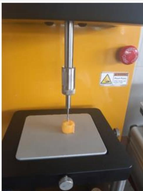
**Determinación de la textura en mango deshidratado por osmosis y aire caliente**
