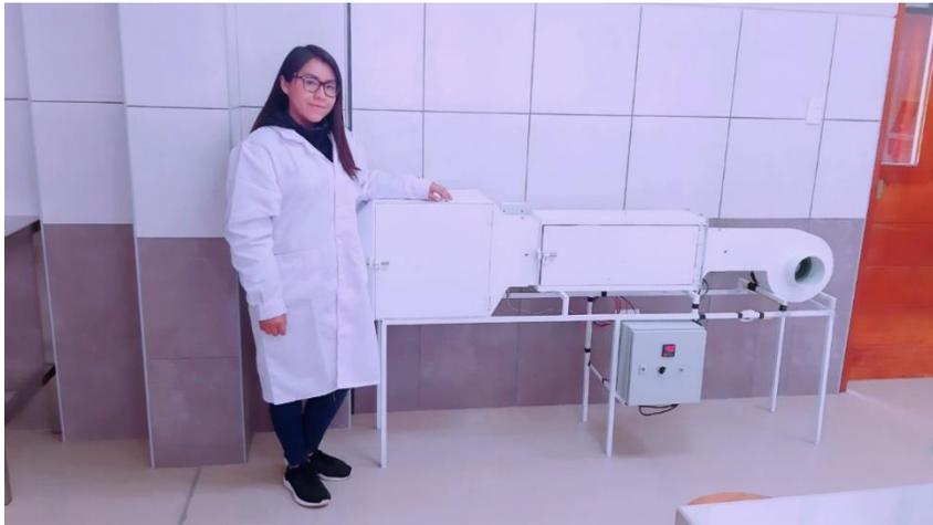
*Nota.* La figura muestra el deshidratador de aire caliente.
