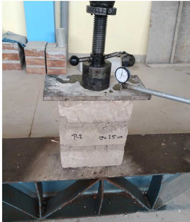
Figura 26: Ensayo de compresión axial de pila de adobe.
