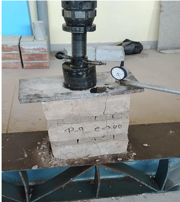
Figura 27: Ensayo de compresión axial de pila de adobe.
