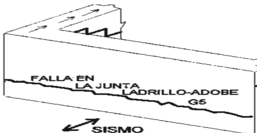
Figura 6: Falla en la junta de adobe
