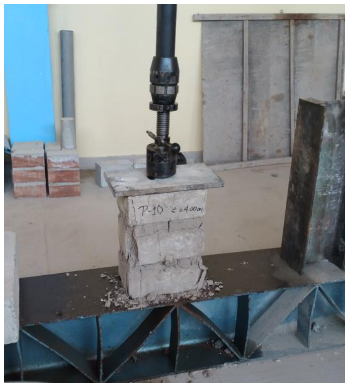
Figura 28: Ensayo de compresión axial de pila de adobe.
