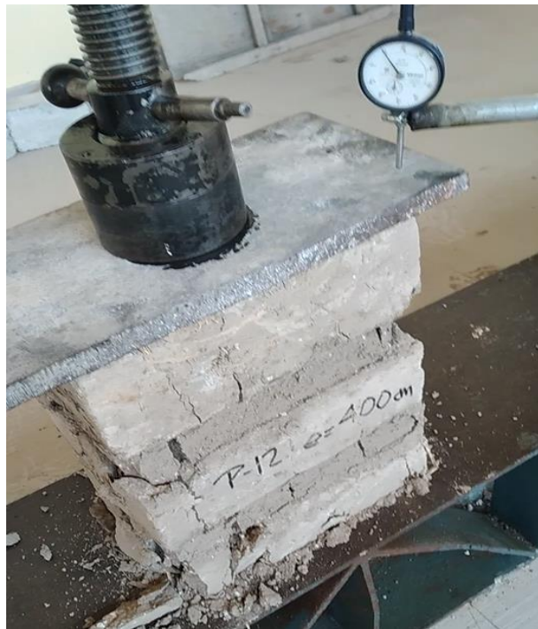
Figura 29: Ensayo de compresión axial de pila de adobe.
