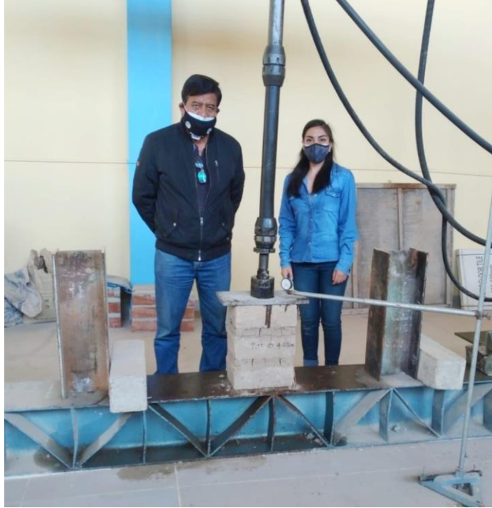
Figura 25: Ensayo de compresión axial en pila de adobe.
