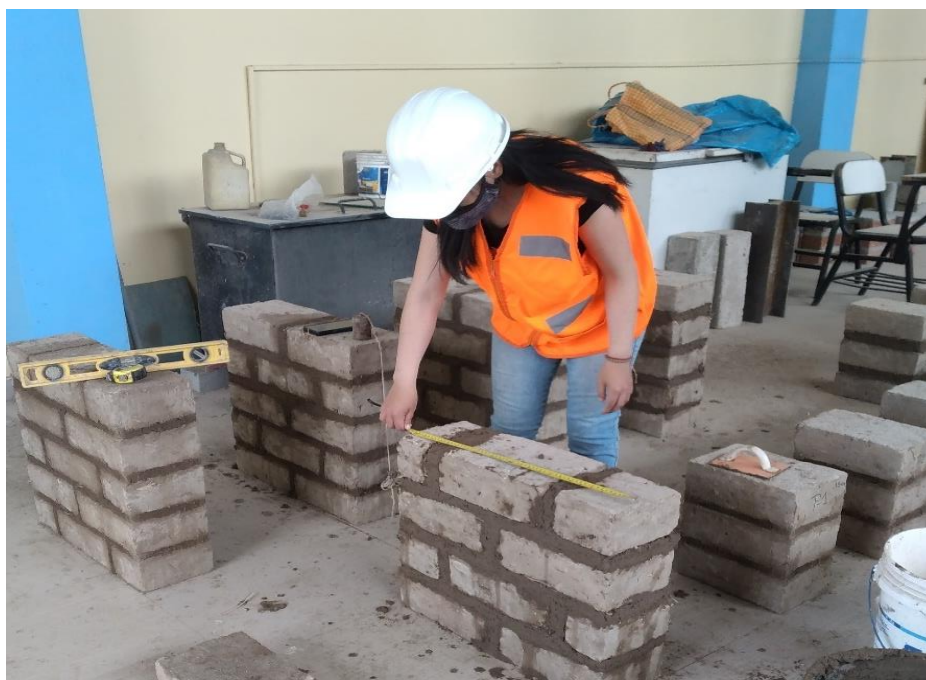
Figura 24: Medición de los muretes de adobe para seguir la norma E 080.
