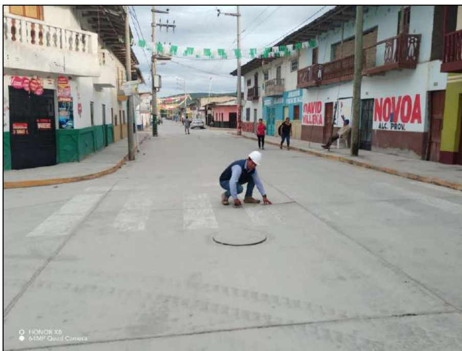
Figura 74: Se observa la identificación de las fallas y la cuantificación de las mismas, específicamente en la UM-01 de la sección 2, ubicada en la cuadra 10 de la vía en estudio.
